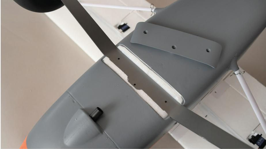
Auch untenrum picobello. Der Alu-Fahrwerksbügel ruht auf einem stabilen Kunststoffformteil. Die exakt passend zum Rumpf gefärbte Plastikabdeckung schließt die Lücke wieder.
