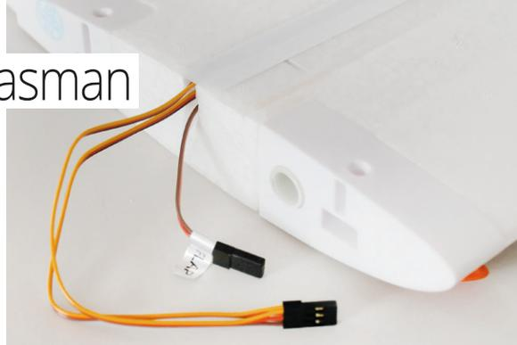
Zwei Servos, drei Kabel? Ja, eines versorgt das LED-Positionslicht und ist praktischerweise gleich mit dem Querruderservo auf einem Stecker verbandelt.
