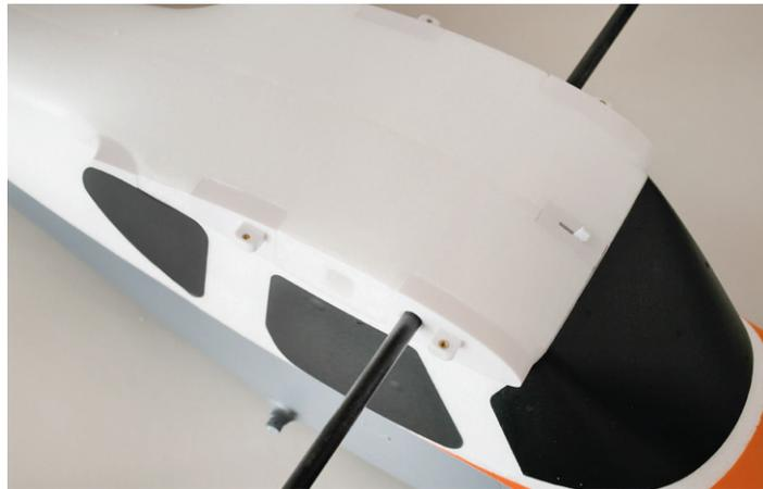
Stecken, schrauben, klipsen. Die Tragflächenhälften sitzen superstabil am Rumpf. Die Metallgewindeein-sätze sorgen auch an dieser häufig beanspruchten Stelle für Langlebigkeit.
