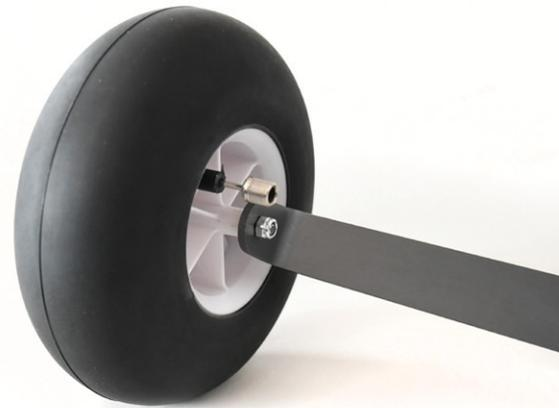
Die Ballonräder sind eine Wucht. Mit dem beiliegenden Ventiladapter lassen sie sich per Luftpumpe befüllen. Wenig Druck federt gut auf rauen Pisten, härter aufgeblasen rollen sie leichter.
