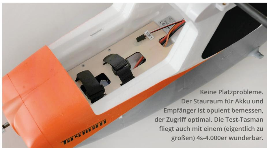
Keine Platzprobleme. Der Stauraum für Akku und Empfänger ist opulent bemessen, der Zugriff optimal. Die Test-Tasman fliegt auch mit einem (eigentlich zu großen) 4s-4.000er wunderbar.
