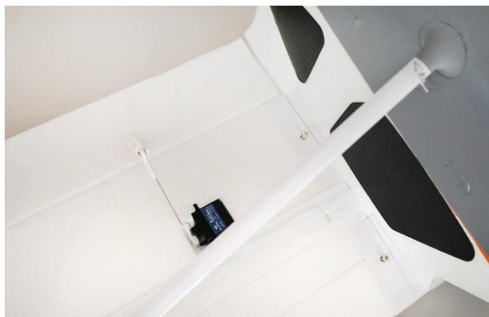
Bitte wenden. Die Flächenhälften werden von unten gesichert. Zum bequemen Schrauben braucht es einen Inbusschlüssel mit schlankem Griff.
