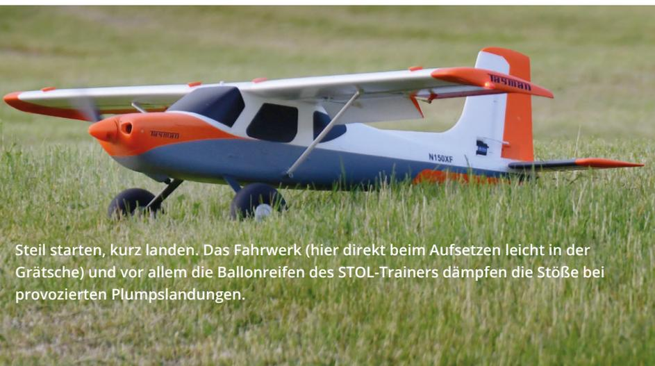
Steil starten, kurz landen. Das Fahrwerk (hier direkt beim Aufsetzen leicht in der Grätsche) und vor allem die Ballonreifen des STOL-Trainers dämpfen die Stöße bei provozierten Plumpslandungen.
