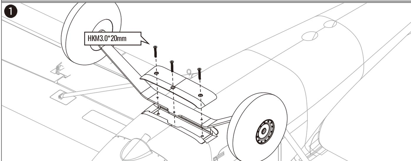
Setzen Sie das Hauptfahrwerk in den Schlitz des Bodens ein und befestigen Sie es mit der Fahrwerksabdeckung und den mitgelieferten Schrauben.
