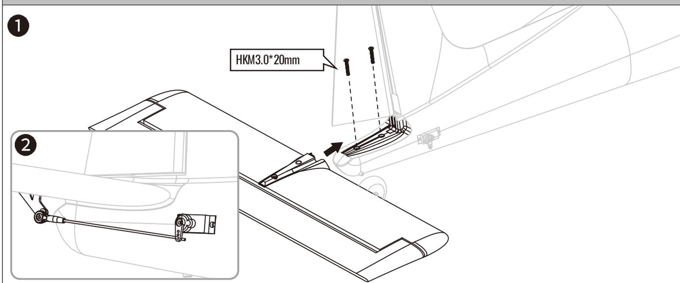
1. Setzen Sie das Höhenleitwerk wie abgebildet in den Schlitz des Hecks und befestigen Sie es mit den mitgelieferten Schrauben.
