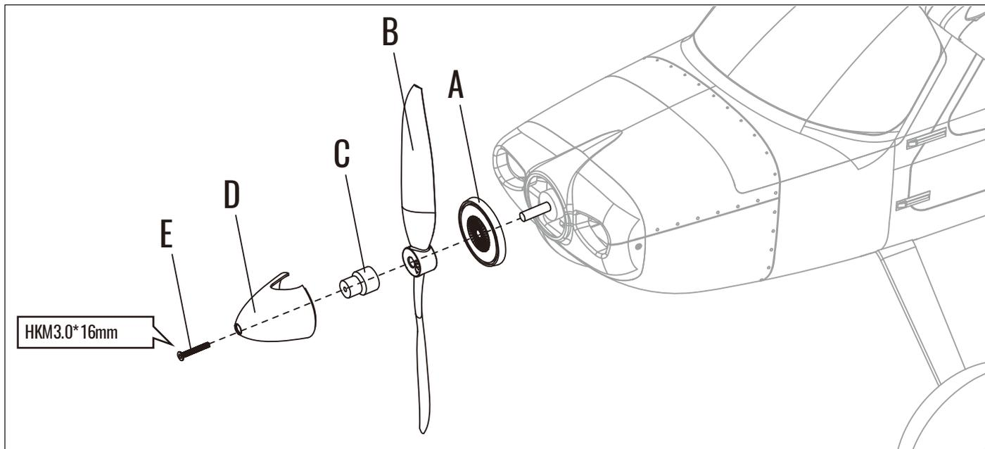
Montieren Sie das Spinner Set und den Propeller in der Reihenfolge A bis E.
