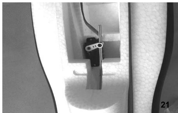
**Bild 21** – Verbinden Sie die Anlenkstange mit dem Servo.
