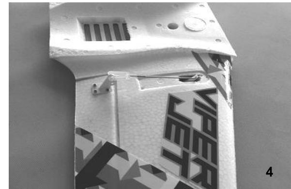
**Bild 4** – Verbinden Sie die Anlenkstange mit dem Servo und den Ruderhorn.
