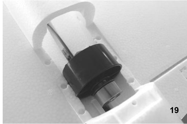
Bild 19 – Kleben Sie den Impeller wie gezeigt in den Rumpf.
