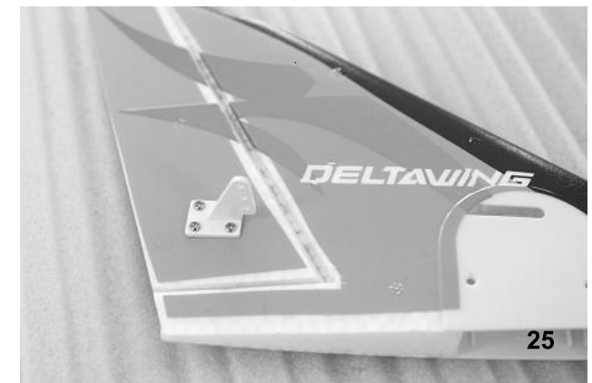
Bild 25 – Montieren Sie das Ruderhorn am Seitenruder.
