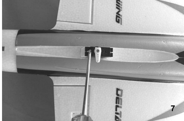
Bild 7 – Sichern Sie den Servo mit Schrauben.
