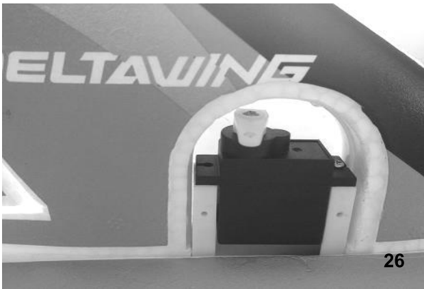
Bild 26 – Bringen Sie Kleber an der Servoausbuchtung des Seitenruders an und befestigen Sie den Servo entsprechend. Kleben Sie anschließend das Seitenruder ein. Achten Sie darauf, dass es es gerade zum Rumpf ausgerichtet ist.
