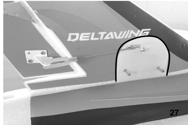
Bild 27 – Verbinden Sie das Gestänge mit dem Servoarm und anschließend mit dem Ruderhorn. Fixieren Sie anschließend die Abdeckung mit den Schrauben. Vorsicht! die Servoabdeckung sind werkseitig montiert. Durch Schneiden des Aufklebers entlang des Schlitzes kann die Abdeckung abgenommen werden um das Servo auszutauschen.
