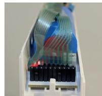
**Achtung! Bei Anschluss des Prüftasters ist darauf zu achten, dass die Kontaktseite des Kabels zur Platine richtig zeigt, sonst keine Funktion!**
