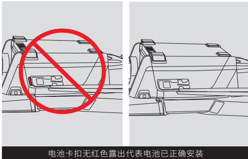
电池卡扣无红色露出代表电池已正确安装
