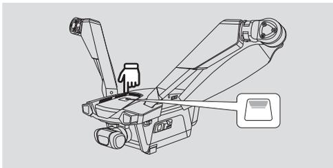
\* 注意：不需要手动旋转电机，起飞前电机角度将自动就位。
