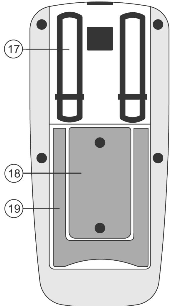
17 Příchytky hrotů měřících kabelů.
