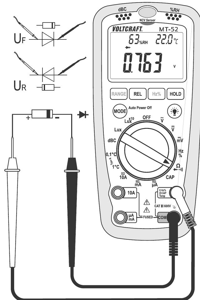
Tímto měřením zjistíte napětí diod v propustném směru ( $U_F$ ) nebo v závěrném směru ( $U_R$ ).
