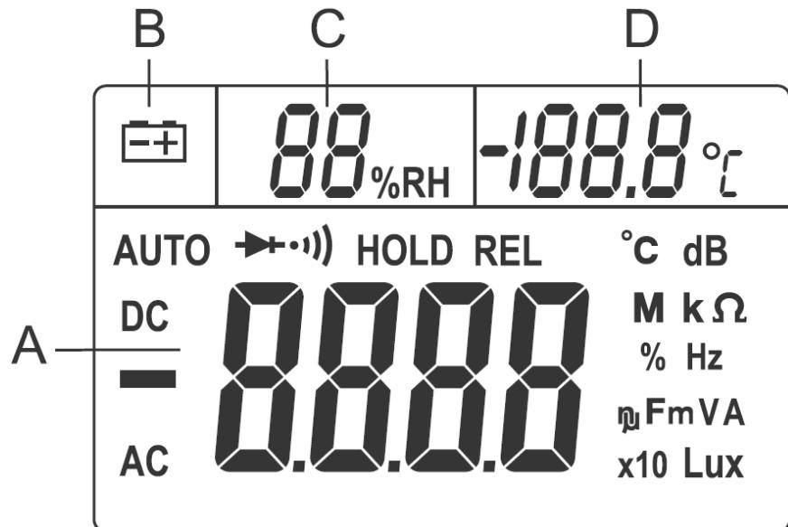
**A** Hlavní segment displeje. Zobrazení naměřených hodnot, jednotek měření a symbolů přídavných funkcí.
