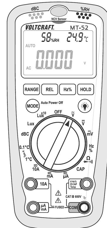
Vypněte přístroj přepnutím otočného přepínače funkcí měření do polohy „OFF“.
