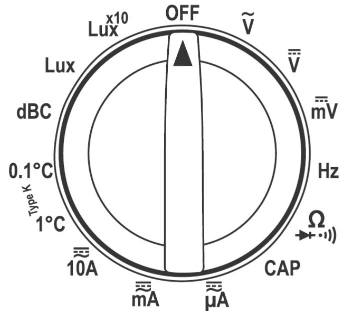
Jako prvek k nastavení příslušných funkcí měření slouží otočný přepínač. Pomocí tohoto přepínače měřící přístroj zapnete a vypněte (poloha „OFF“).
