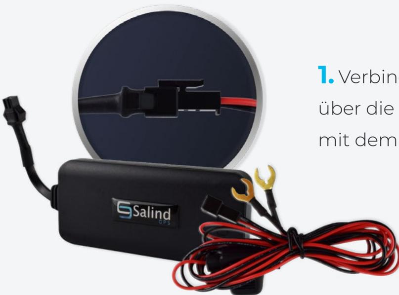
**1.** Verbinden Sie den Salind 01 über die schwarze Steckfunktion mit dem Kabelbaum.
