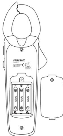
**Ne laissez jamais des piles usagées dans l'instrument de mesure, car même les piles protégées contre les fuites peuvent s'oxyder et ainsi libérer des produits chimiques qui nuiront à votre santé ou détruiront l'appareil.**
