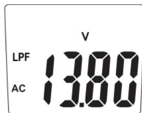
**!** Die LPF-Funktion ist nur im AC-Spannungs-Messbetrieb möglich.
