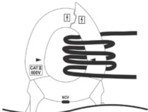
En cas de courant faible, le conducteur peut être plusieurs fois pris pour être enroulé autour d'une mâchoire de la pince de manière à augmenter le total du courant mesuré. Ensuite, divisez la valeur mesurée du courant par le nombre d'enroulements autour de la pince ampèremétrique. Vous obtiendrez alors la valeur correcte du courant.
