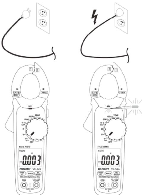
→ Testez toujours la fonction NCV d'abord sur une source de tension CA connue afin d'éviter toute erreur de détection. En cas d'erreur de détection, il y a risque de décharge électrique. De nombreux câbles sont fabriqués avec des conducteurs internes torsadés. Pour cette raison, passez la sonde sur quelques centimètres de la longueur du câble de manière à capturer tous les conducteurs internes.
