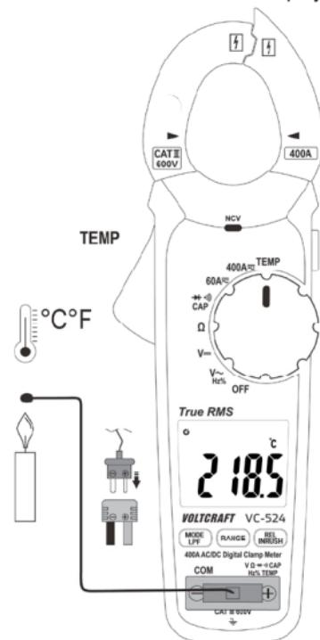
→ Wird kein Temperaturfühler angeschlossen, kann die Umgebungs-temperatur des DMM durch eine Kurzschlussbrücke über die beiden Messbuchsen „COM“ und „Temp“ angezeigt werden. Da sich der Fühler im inneren des Gehäuses befindet, reagiert die Anzeige sehr träge auf Temperaturschwankungen. Diese Funktion hilft Ihnen die korrekte Betriebstemperatur nach einer Lagerung zu kontrollieren. Für schnelle Messungen muss ein externer Fühler eingesetzt werden.
