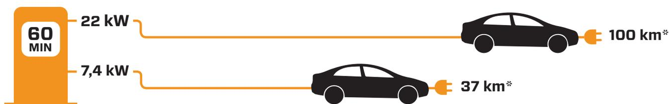
\* Ladekabel 22 kW: Abhängig vom Model des Elektrofahrzeugs: Ladezeit eine Stunde – Reichweite bis zu 100 km
