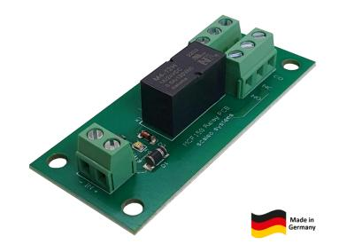
Relaisspannung: 8 - 16 VDC
