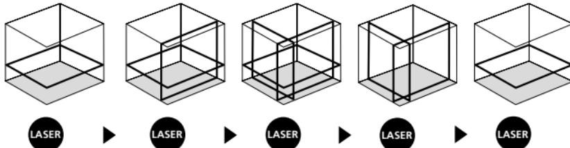
! Til horizontal og vertikal nivellering skal transportsikringen være løsnet. Så snart apparatet er uden for det automatiske nivelleringsområde på 3,5°, blinker laserlinjerne. Apparatet skal positioneres således, at det er inden for nivelleringsområdet. Laserlinjerne lyser konstant op igen.
