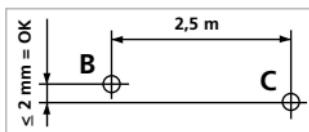
! Compruebe regularmente la calibración antes del uso, después de los transportes y después de almacenajes prolongados.
