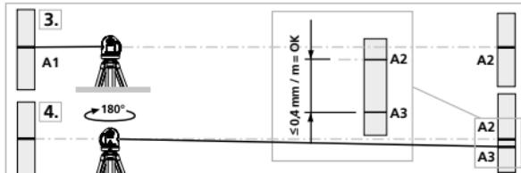
! Si A2 y A3 se encuentran a más de 0,3 mm / m entre sí, será necesaria un ajuste. Póngase en contacto con su distribuidor especializado o diríjase al Servicio Técnico de UMAREX-LASERLINER.
