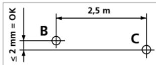
Sie, ob die waagerechte Linie von Punkt C  $\pm 2 \text{ mm}$  auf der gleichen Höhe mit dem Punkt B liegt. Vorgang durch Schwenken nach links wiederholen.
