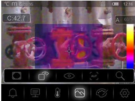
En el modo de **MIX Image**, se muestra una sección de la imagen de infrarrojos en la imagen digital.
