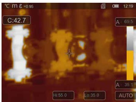
Áreas com uma temperatura dentro da temperatura ajustada do alarme acima e do alarme abaixo são coloridas a laranja.
