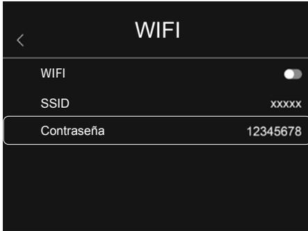
Se puede establecer una conexión con el aparato a través de WIFI. El SSID estándar es „TCHS“ o „TCHS Pro“ y la contraseña estándar es „12345678“. Tras la conexión con la aplicación Laserliner HighSense, se puede acceder a los datos de la cámara.
