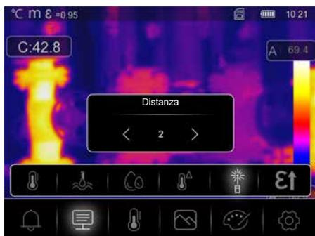
Nell'aria sono presenti numerose sostanze che possono assorbire i raggi infrarossi. Pertanto, con l'aumentare della distanza si riduce la radiazione infrarossa dell'oggetto analizzato. In qualsiasi caso, a partire da una distanza di 10 metri tenere presenti gli effetti atmosferici dell'aria. La distanza può essere regolata in un intervallo compreso tra 0 e 2.000 metri.
