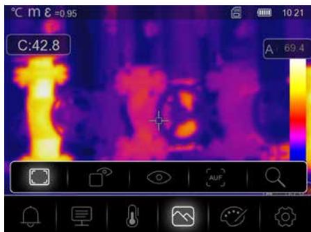
Hay cinco modos de imagen diferentes para la visualización: IR térmico, MIX Image, Imagen visible, Auto Fusion, Zoom.
