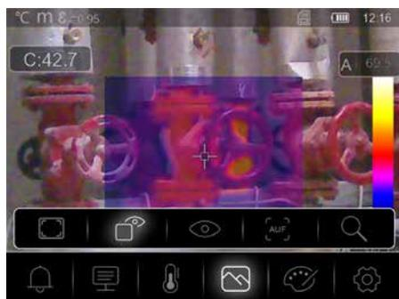
Nella modalità **Fusione** si visualizza una sezione dell'immagine a infrarossi in quella digitale.
