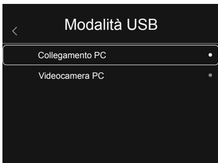
Nella modalità USB si possono trasferire a un computer i dati registrati dalla termocamera. Il computer può essere utilizzato per una trasmissione in diretta per consentire a più persone di osservare le immagini della termocamera. Terminato l'utilizzo sul computer, espellere correttamente l'unità disco USB per evitare errori di lettura sul computer.
