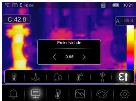
O grau da radiação por infravermelhos, que cada corpo emite conforme o material/a superfície, é determinado pelo grau de emissão (0,01 ... 1,0). Para uma medição correta é absolutamente necessário ajustar o grau de emissão. Para além dos graus de emissão definidos na lista de materiais também é possível ajustar um grau de emissão individual.
