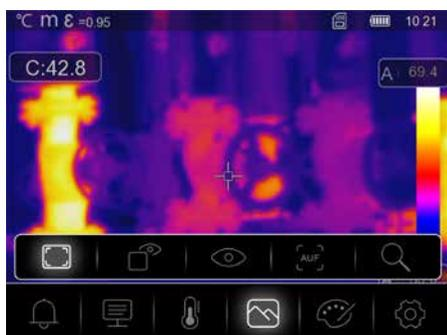
Ci sono cinque diverse modalità di visualizzazione delle immagini: Termica a infrarossi, Fusione, Immagine visibile, Fusione automatica, Zoom.
