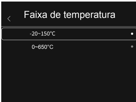
A seleção prévia da gama de temperatura pode ser realizada neste menu. Há duas gamas à disposição: -20 - 150 °C (ideal para termografia de construções em interiores e exteriores) 0 - 650 °C (ideal para aplicações industriais)
