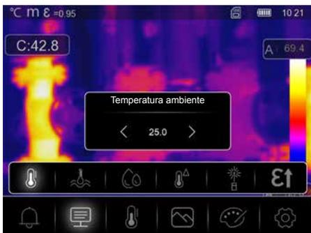
A temperatura ambiente tem influência sobre a medição da câmara de termografia. Através destes parâmetros pode ser compensada a influência da temperatura ambiente sobre a medição. O ajuste é possível entre 0 °C e 50 °C.
