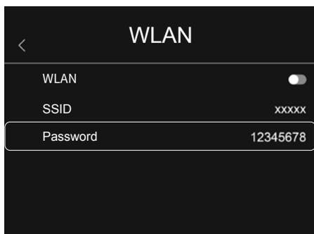
Tramite la rete WLAN si può creare un collegamento con l'apparecchio. Il nome della rete (SSID) è "TCHS" o "TCHS Pro" e la password predefinita è "12345678". Una volta collegati all'app HighSense di Laserliner si può accedere ai dati della videocamera.
