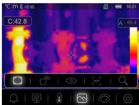
Existem cinco modos de imagem diferentes para exibição: Térmica, MIX Image, Visível, Auto Fusão, Zoom.
