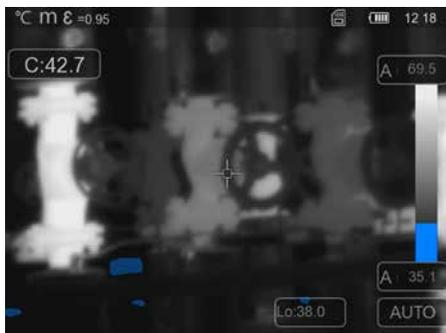
Áreas com uma temperatura inferior à temperatura ajustada do alarme abaixo são coloridas a azul.
