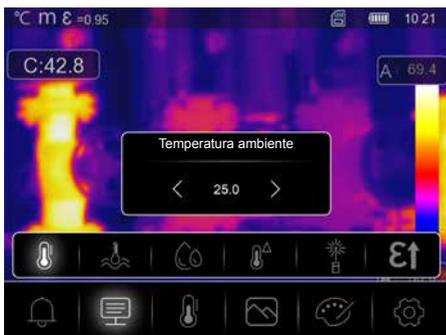
La temperatura ambiente influisce sulla misurazione della termocamera. Regolando questo parametro si può compensare l'effetto della temperatura ambiente sulla misurazione. L'impostazione può essere eseguita nell'intervallo 0°C - 50 °C.
