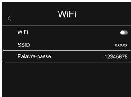
Através do WiFi pode ser estabelecida uma ligação com o aparelho. O SSID padrão é "TCHS" ou "TCHS Pro" e a palavra-passe padrão é "12345678". Após a ligação com a app Laserliner HighSense tem-se acesso aos dados da câmara.
