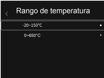
La preselección del rango de temperatura puede realizarse en este menú. Hay dos zonas disponibles: -20 - 150 °C (óptimo para la termografía de edificación en interiores y exteriores) 0 - 650 °C (óptimo para aplicaciones industriales)
