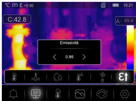
Il grado di radiazione infrarossa emesso da qualsiasi corpo, a seconda del tipo di materiale o della superficie, viene determinato dal grado di emissione (da 0,10 a 1,0). Affinché la misurazione sia corretta, è assolutamente necessario impostare il grado di emissione. Oltre ai gradi di emissione predefiniti contenuti nella lista dei materiali, si possono anche impostare gradi di emissione individuali.
