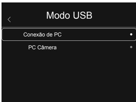
No modo USB é possível transmitir os dados registados da câmara de termografia para um PC. Para possibilitar a visualização da imagem da câmara a várias pessoas ao mesmo tempo, o PC pode ser usado para a transmissão ao vivo. Após a utilização no PC, a unidade de USB tem de ser ejetada corretamente para evitar erros de leitura no PC.
