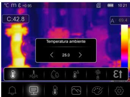
La temperatura ambiente influye en la medición de la cámara termográfica. Este parámetro permite compensar la influencia de la temperatura ambiente en la medición. Se puede ajustar entre 0 °C y 50 °C.
