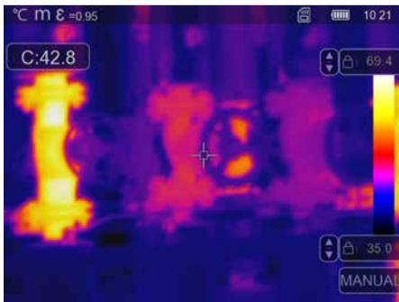
**🔒** Nell'impostazione manuale, la gamma di temperature non viene più impostata automaticamente tramite i valori di temperatura min. e max. misurati, ma definita con i valori manuali.
