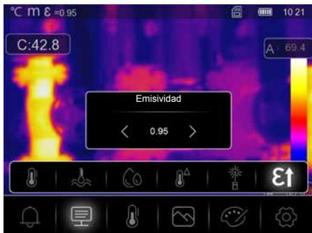
El grado de radiación de infrarrojos que cada cuerpo emite, según su material y superficie específicos, se determina con el grado de emisión (0,01 ... 1,0). Ajustar el grado de emisión es imprescindible para garantizar que la medición sea correcta. Además de los grados de emisión incluidos en la lista de materiales, es posible también ajustar un grado de emisión individual.
