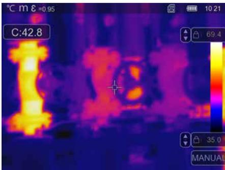
**🔒** No ajuste manual, a margem de temperatura não é ajustada automaticamente através dos valores mín./máx. medidos, mas sim definida através de valores manuais.
