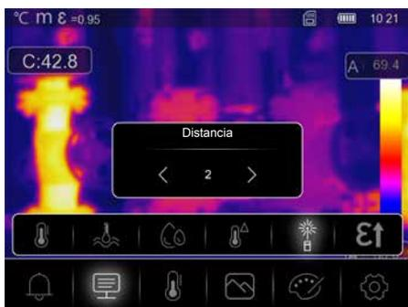
Hay numerosas sustancias en el aire capaces de absorber los rayos infrarrojos. Debido a ello se reduce la radiación infrarroja del objeto examinado con el aumento de la distancia. A partir de una distancia de 10 metros, hay que tener en cuenta en todo caso las influencias atmosféricas del aire. La distancia se puede ajustar entre 0 y 2.000 metros.
