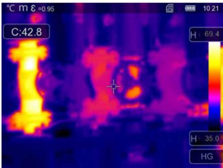
**H** En la configuración del histograma, la distribución del color de la imagen de infrarrojos se adapta de forma similar a como se hace en la configuración automática. Con una evaluación estadística de la distribución de temperatura en la imagen de infrarrojos (histograma) se consigue además una estabilización de los valores mínimo y máximo. Esto estabiliza la vista de imagen a imagen bajo condiciones de temperatura fuertemente fluctuantes (p. ej., en caso de medir objetos en movimiento).
