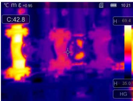
**H** No ajuste de histograma, a distribuição de cores da imagem de infravermelhos é adaptada de modo similar ao ajuste automático. Adicionalmente, através de uma avaliação estatística da distribuição de temperatura na imagem de infravermelhos (histograma) é alcançada uma estabilização dos valores mín./máx. Desta forma, no caso de condições de temperatura fortemente oscilantes ocorre uma estabilização da visualização de imagem para imagem (p. ex. nas medições em objetos móveis).
