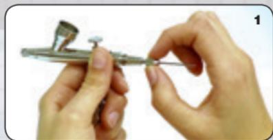
**Grondige reiniging (vóór langere periodes van niet-gebruik): 1.** De persluchtvoevoer uitschakelen. Het eindstuk (L) en de naaldklemmoer (K) losschroeven.
