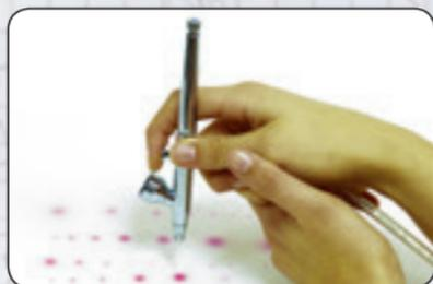
**Punti di nebulizzazione:** per stabilizzare la presa utilizzare entrambe le mani. Iniziare con l'aria, poi trascinare cautamente il pulsante all'indietro, ma solo di poco. Per fare punti più grossi aumentare la distanza e la quantità di colore
