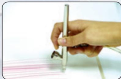
**Linea sottile:** iniziare con l'aria, trascinare indietro il pulsante solo durante il movimento per evitare "puntini". Alla fine spingere di nuovo il pulsante in avanti, poi lasciarlo completamente.
