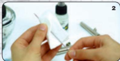
**2.** Estrarre l'ago (I), pulire con un panno e del detergente. Controllare che la punta dell'ago non sia deformata.
