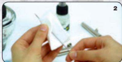
**2.** De naald (I) uittrekken en met een doek en reinigingsmiddel reinigen. De naaldpunt op vervorming controleren.
