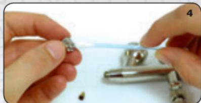
**4.** De luchtkop (B) losschroeven en reinigen.
