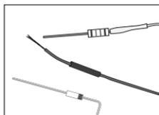
10. In gleicher Weise verfährt man mit dem braunen Kabel, dem schwarzen Schrumpfschlauch und der Diode.
