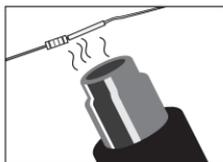
9. Kurz (!) erhitzen, etwa mit einem Heißluftpistole oder einem Feuerzeug. Schon ist die dauerhafte Verbindung fertig! Vorsicht Verbrennungsgefahr!
