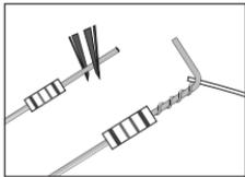
6. Biegen Sie den kurzen Draht des Widerstandes in der Mitte um 90 Grad. Wickeln Sie das blanke Kabelende des gelben Kabels um das Drahtstück direkt unterhalb des Widerstandes.
