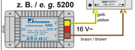
**TIPP: Verteilerleiste mit Powermodul, Art. 5205**
