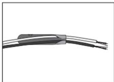
1. Die beiden Kabelenden werden durch den Lampenschirm hindurchgefädelt.
