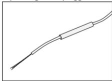
5. Schieben Sie das gelbe Stück Schrumpfschlauch auf das gelbe Kabel. Isolieren Sie das Kabel ca. 8 – 10 mm ab.
