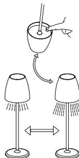
Laden Sie die Lampe zunächst mit dem A1-Ladegerät 4-5 Stunden lang auf.
