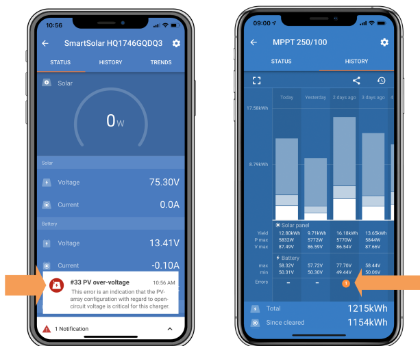
VictronConnect-App: Screenshot eines #33-Fehlers und Screenshot der Historie mit Fehleranzeige
