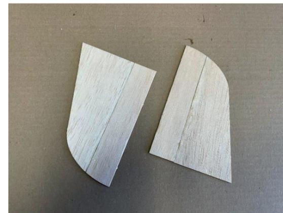
Teile der Tragflächenauflage A2 und A4 in das Tragflächenmittelstück einkleben.
