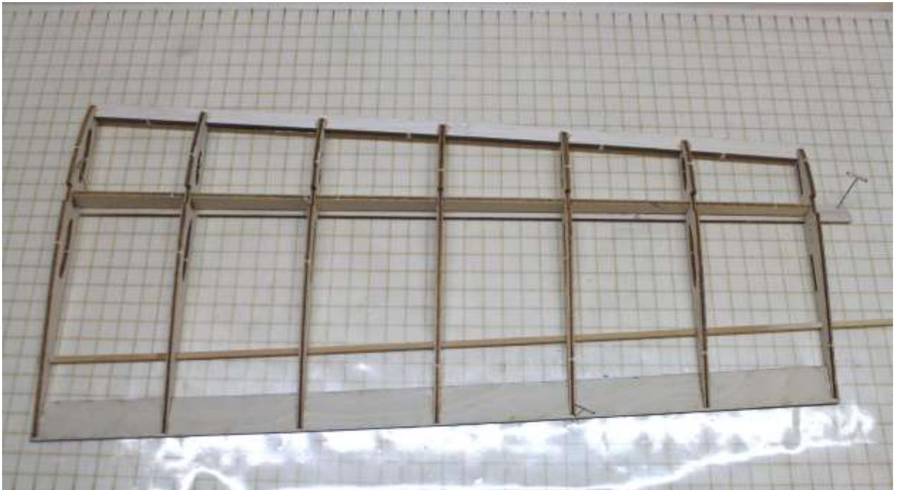
Endleiste (C2) an Rippenenden schieben und verkleben
