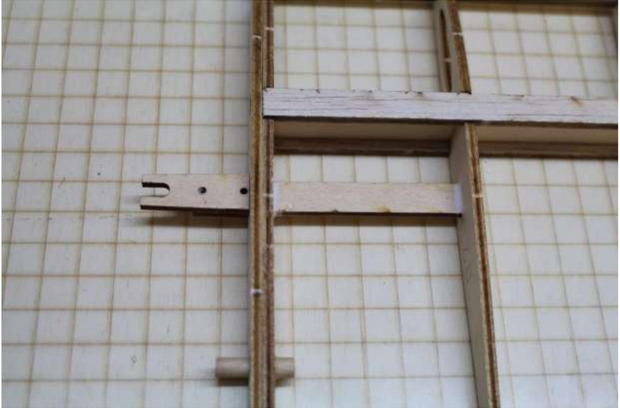
Tragflächensicherung aus (F4) und (F3) verleimen. Danach in Deckrippe (B4) bis Rippe (A2) einschieben und verleimen. Das Gegenstück zur Tragflächensicherung (F2) wird später in die linke Tragflächenhälfte eingebaut
