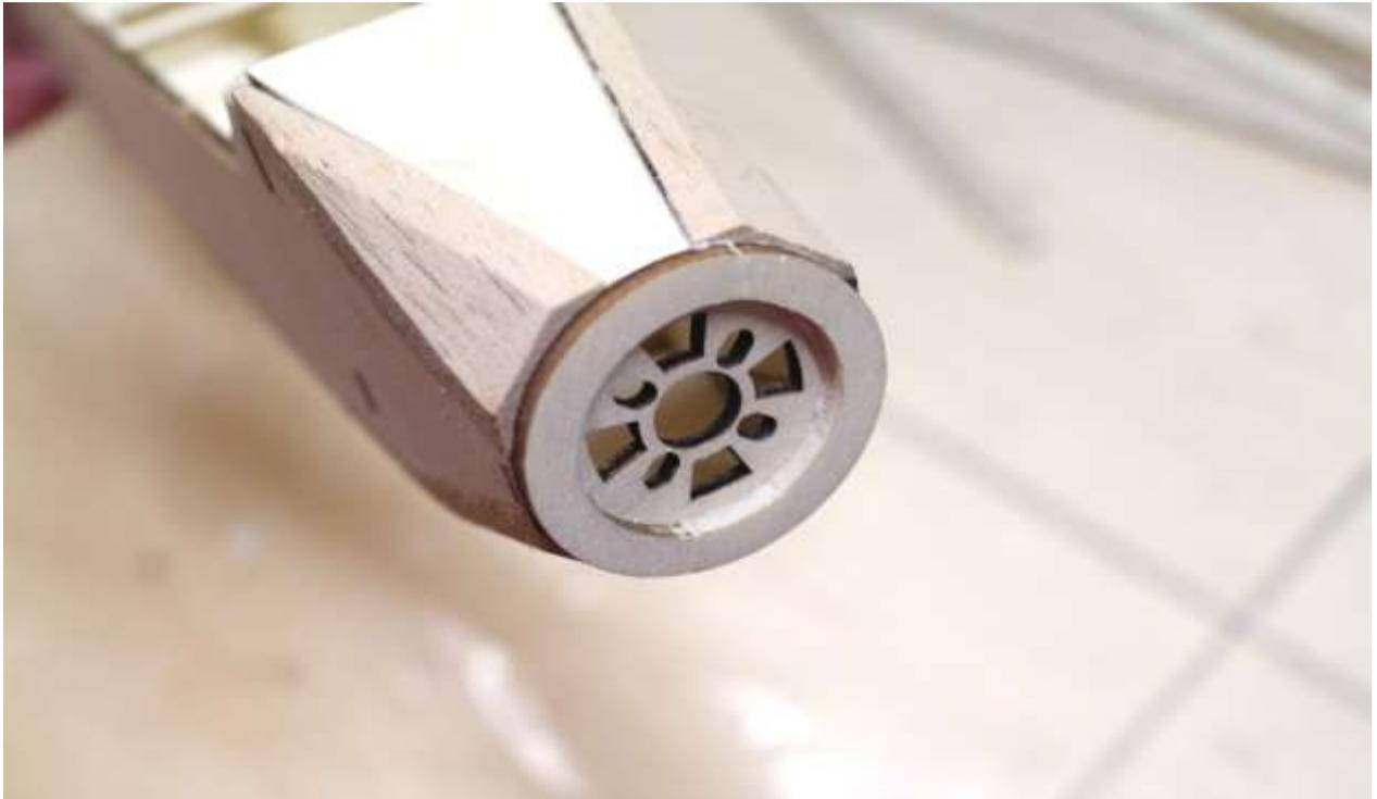
Frontring (H7) genau mittig auf Motorspant (F1) verleimen
