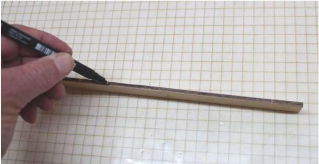
Eine Mittellinie an den Endleisten der Dämpfungflächen und an den Vorderleisten der Ruderblätter anzeichnen (im Bild das Höhenruder)
