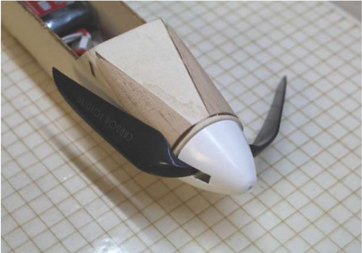
Klapp-Luftschraube komplettieren und auf Motorwelle befestigen
