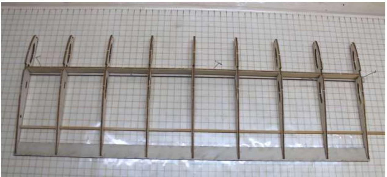
Endleiste (C1) an Rippenenden schieben und verkleben
