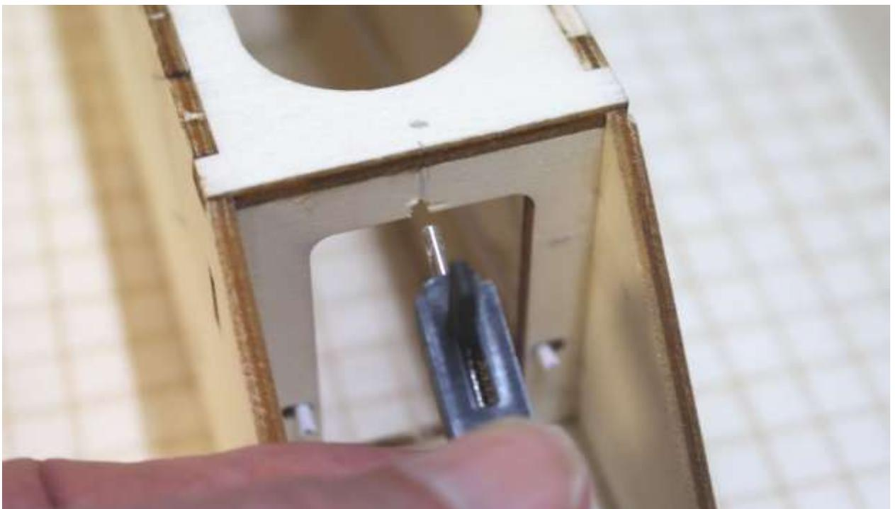
Kleines Halbrund mittig in Spant (G2) für Verriegelungsstange feilen
