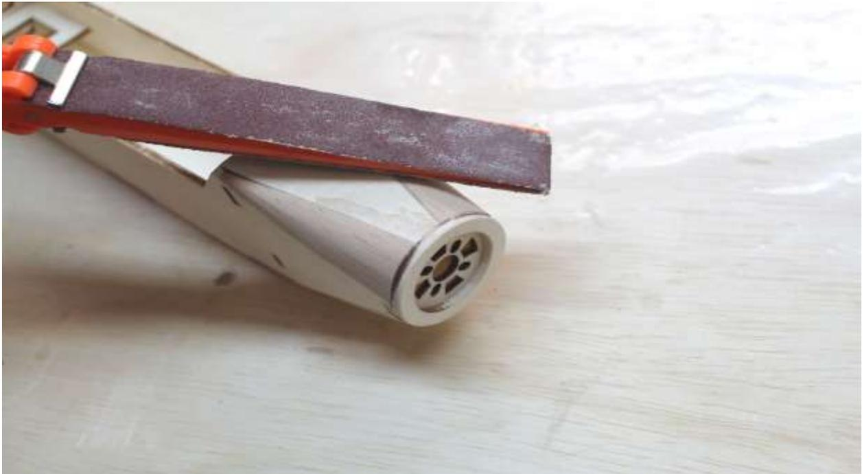
Rumpfspitze verschleifen. Dazu Formteile (K5) der Rundung des Frontringes (H7) anpassen
