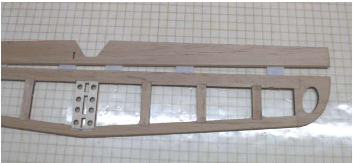
Scharniere an beiden Leitwerken einbringen, Ruderklappen anstecken
