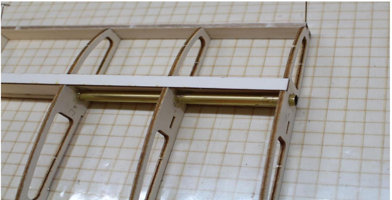
Führungsrohr für Tragflächensteckung (Messing,  $\text{Ø}9 \times 135 \text{ mm}$ ) in Rippen (J5 – J3) mit 5-min-Epoxy einkleben
