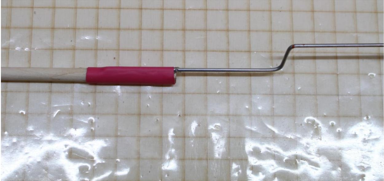
Draht mit 5-min-Epoxy an der Schubstange verkleben.
