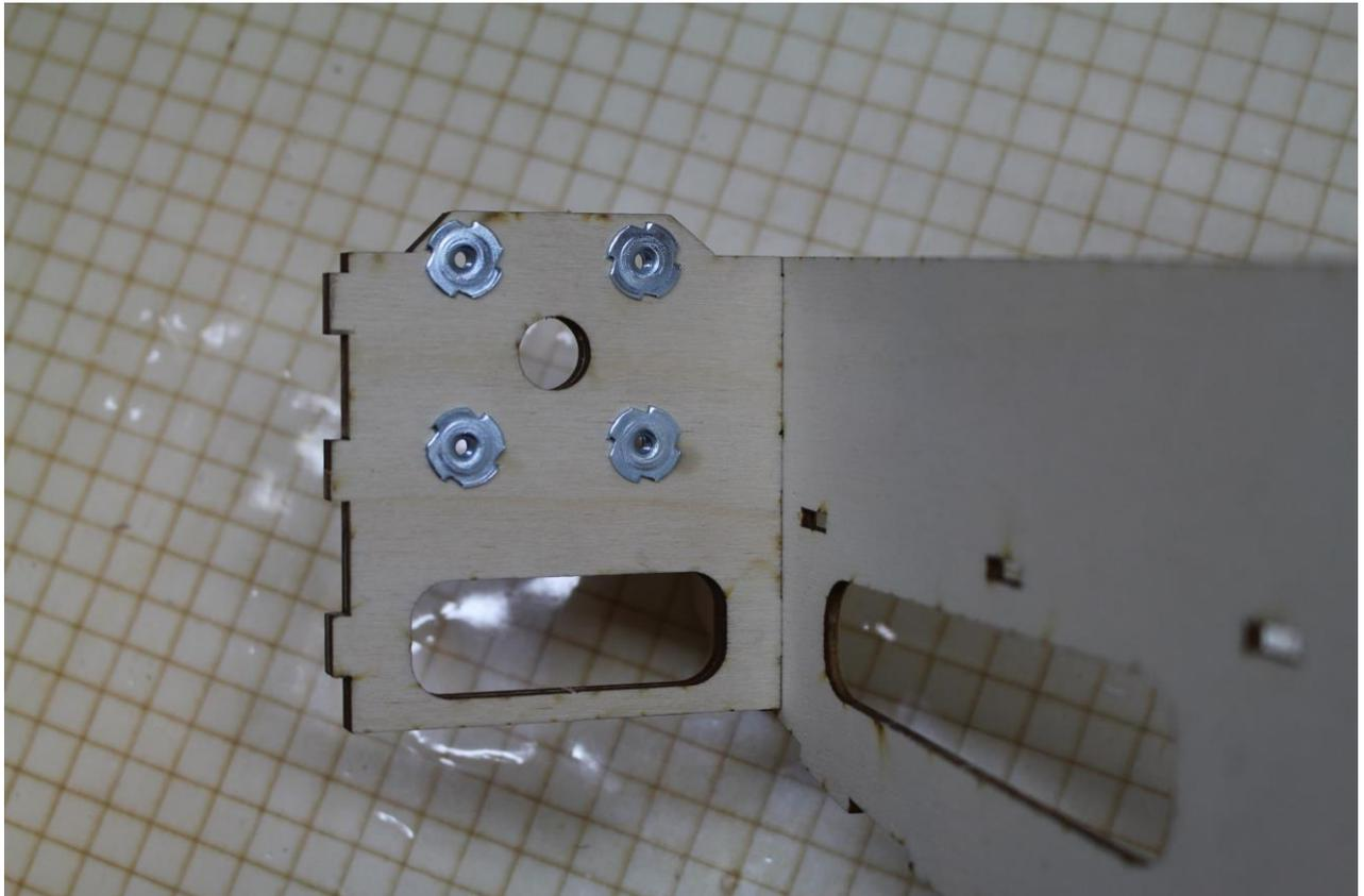
Motorspant (A1) mit Rumpfseitenteil verleimen
