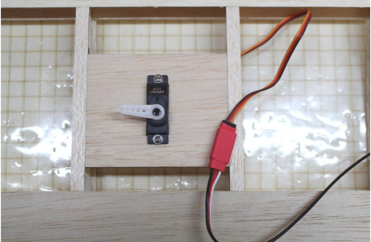
Servos für Querruder und Landklappen in Tragfläche einsetzen und verschrauben
