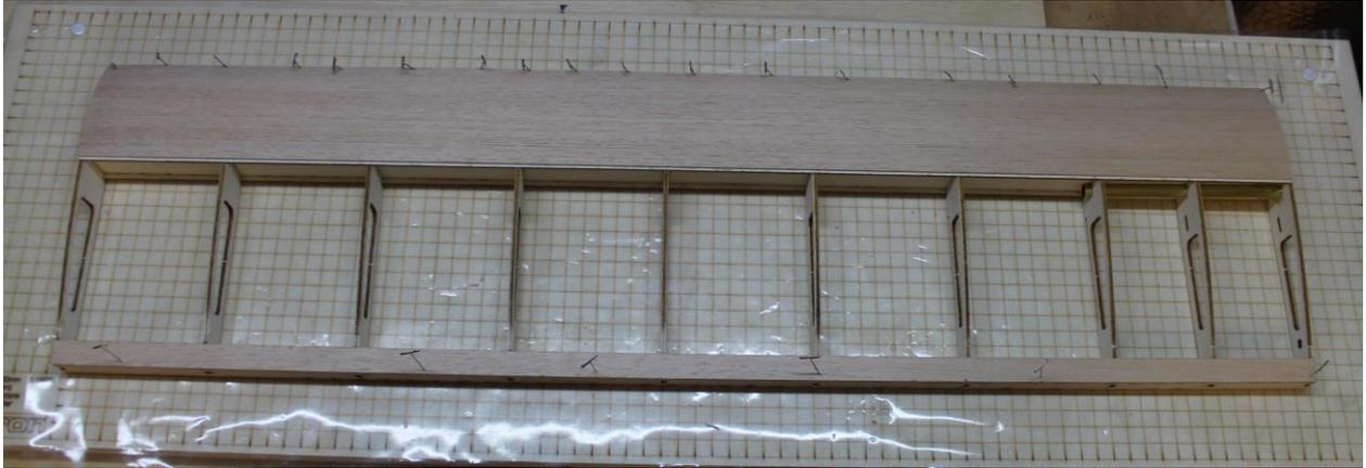
Nasenbeplankung 760×75 mm (1,5-mm-Balsa) zuschneiden und verleimen
