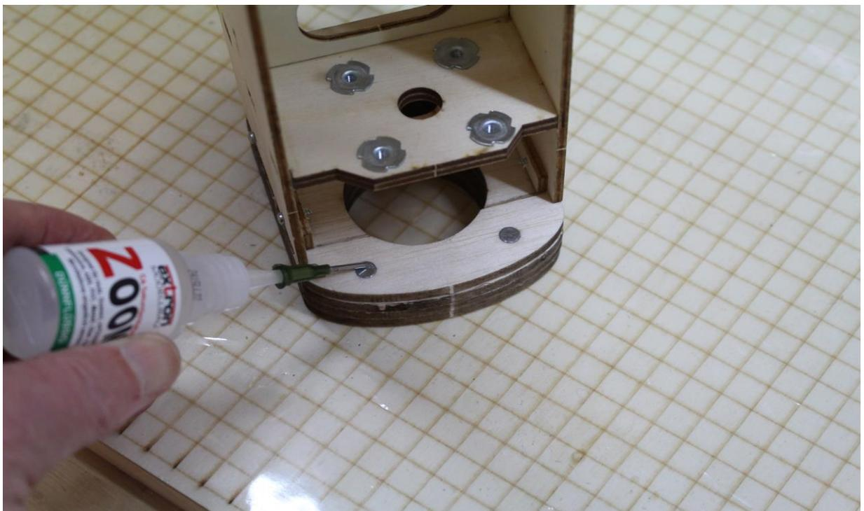
Magneten in Frontverkleidung (G) mit Sekundenkleber einkleben
