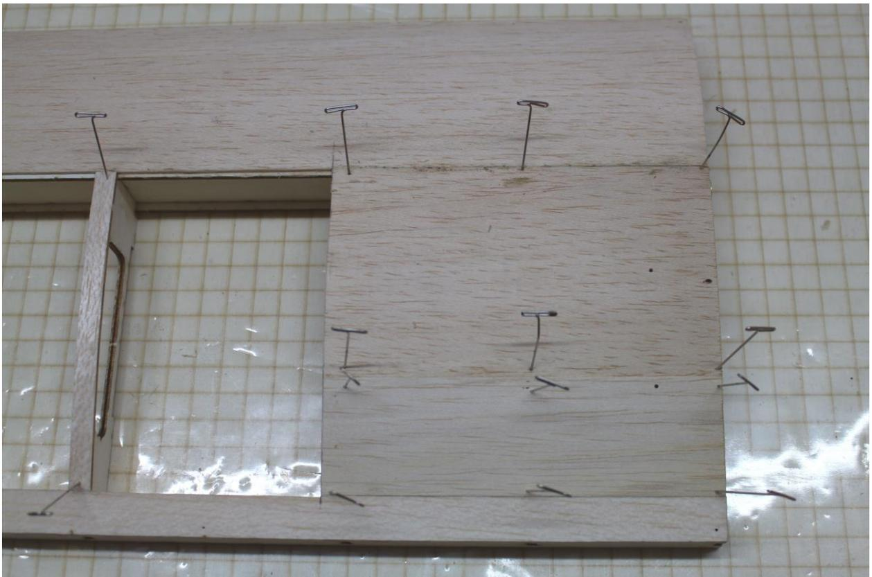
Wurzelbeplankung (1,5-mm-Balsa) zuschneiden und verleimen
