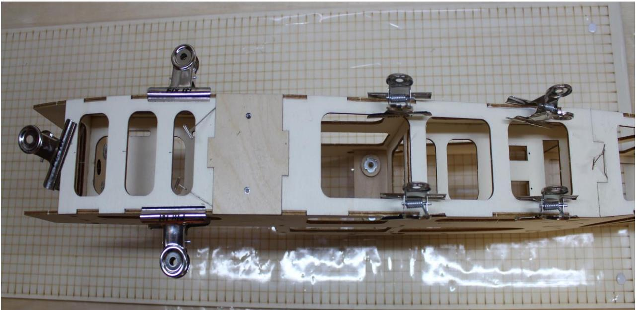
Teile für den vorderen, unteren Rumpfboden (F3 und F5) und Fahrwerksbefestigung (A5/A6) verkleben
