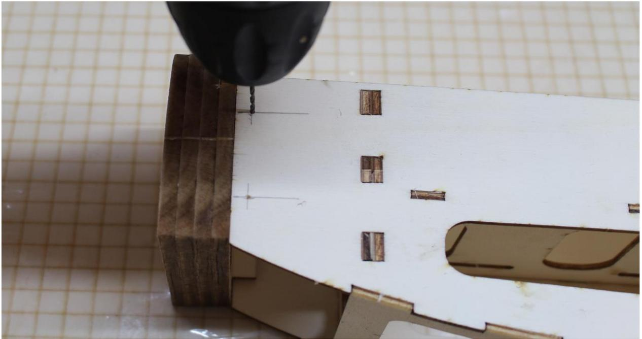
Frontverkleidung (G) einpassen, Laschen (F4) und Rumpfseitenteile mit 1,5 mm vorbohren und je 2× Blechschraube 2×13 eindrehen
