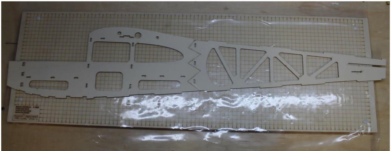
Rumpfseitenteile aus (E1 + C1) und (D1 + B1) verleimen
