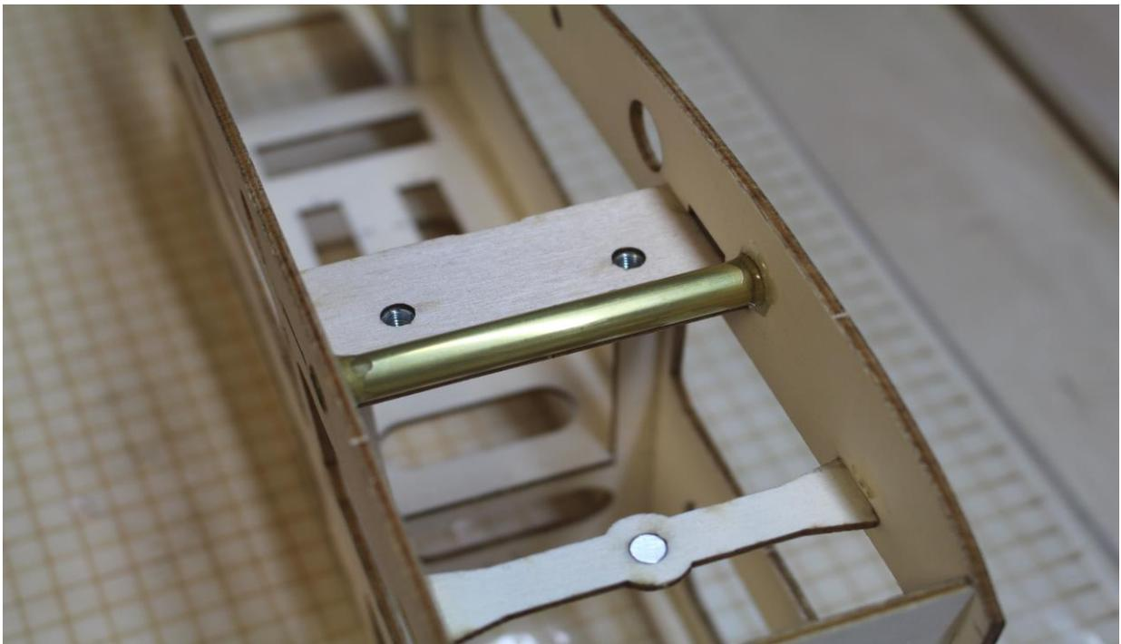
Führungsrohr für Tragflächensteckung (Messing,  $\varnothing 9 \times 80$  mm) zwischen Rumpfteilen mit 5-min-Epoxy einkleben
