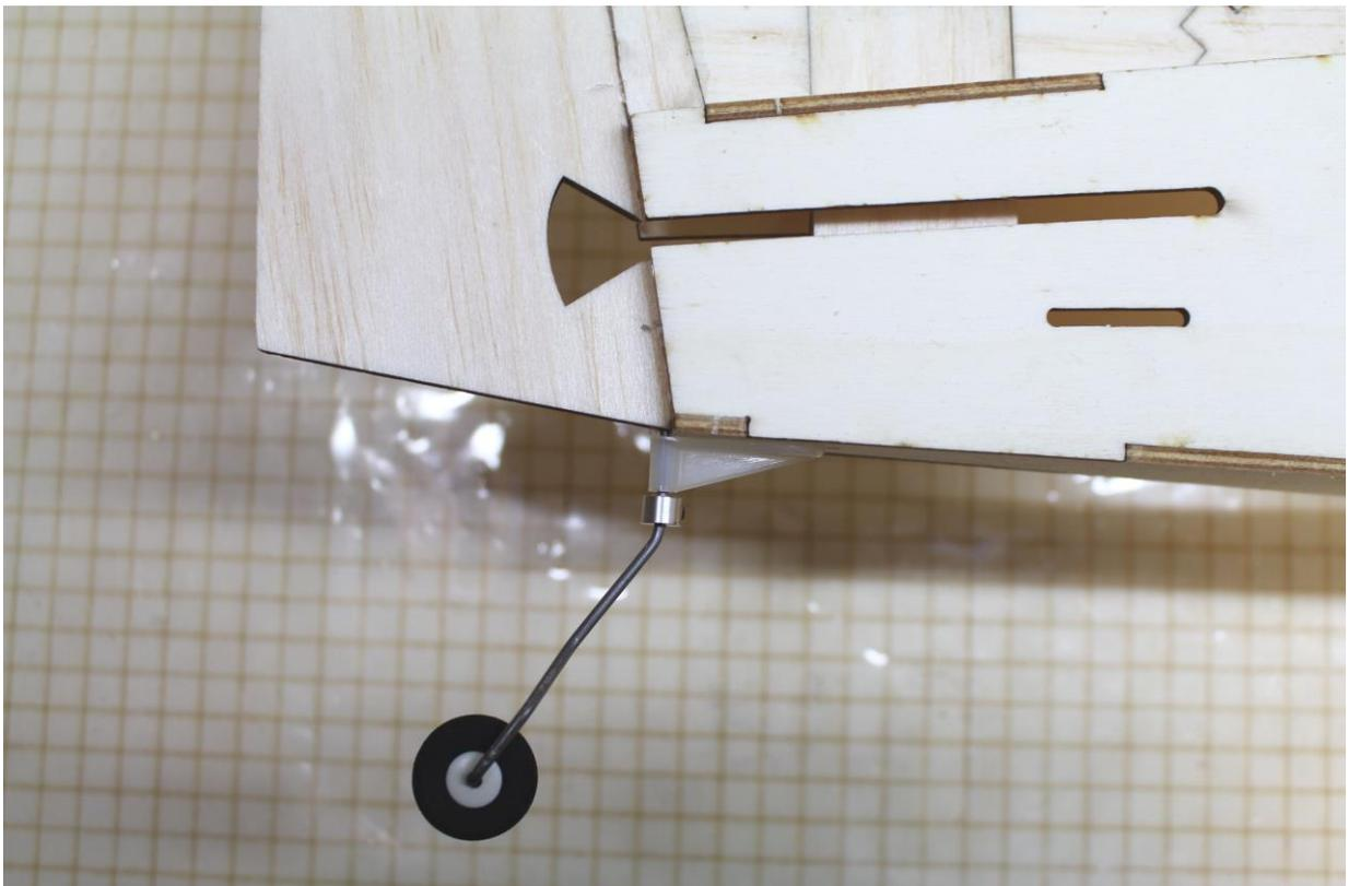
Konsole mit Fahrwerksdraht am Rumpfheck mit 4× Schraube  $\text{Ø}2,2 \times 12$  mm verschrauben. Beim Einsetzen des Seitenruders das abgewinkelte Ende des Fahrwerksdrahtes in den Schlitz und Bohrung einsetzen und mit 5-min-Epoxy verkleben
