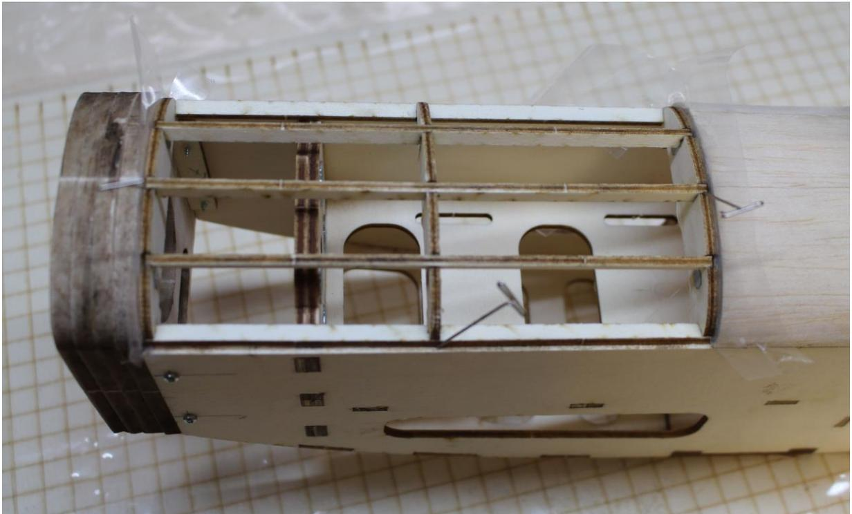
Deckelgerüst aus 2× Halbspann (E2 mit Magneten), Halbspann (E2 ohne Magneten) und 5× Längsurte (D2) verleimen.
