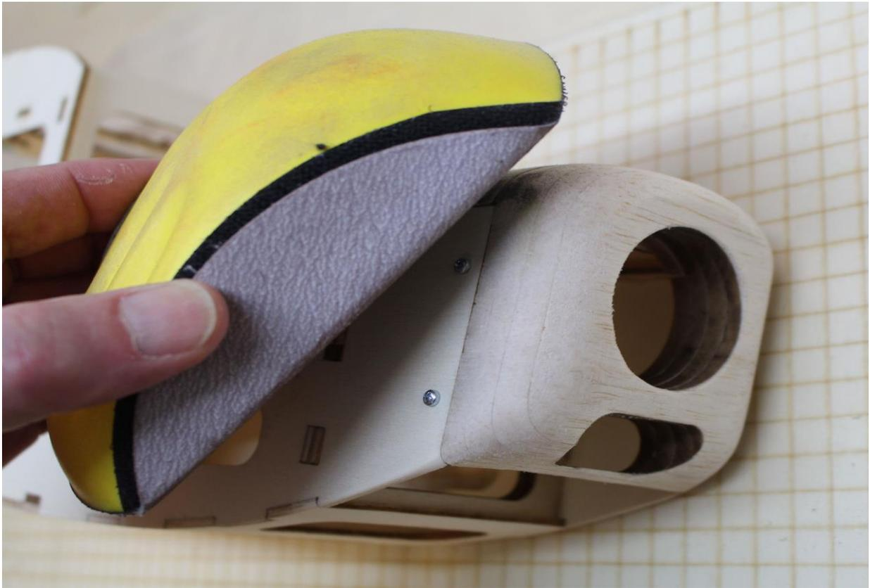
Folienstreifen entfernen, Deckel abnehmen und evt. Überstände und Leimreste verschleifen
