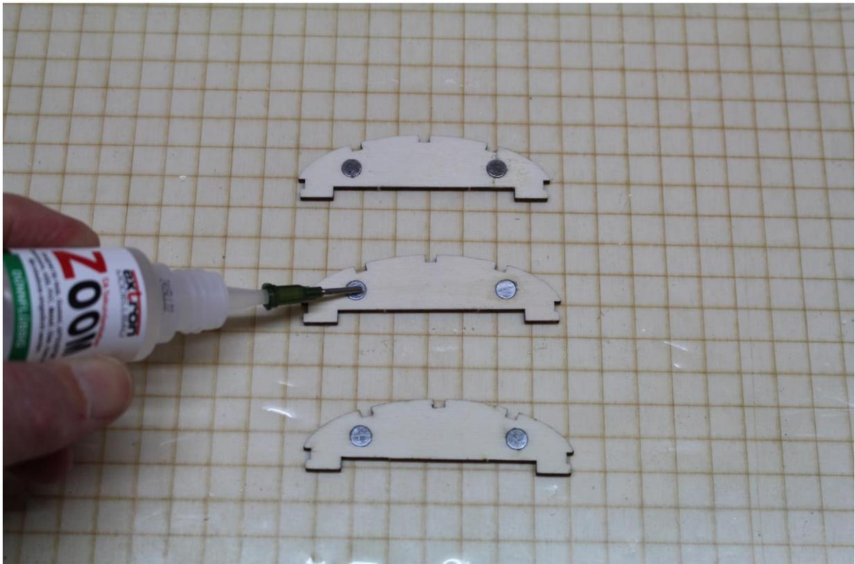
In drei Halbspanten (E2) je 2 Magneten mit Sekundenkleber einkleben
