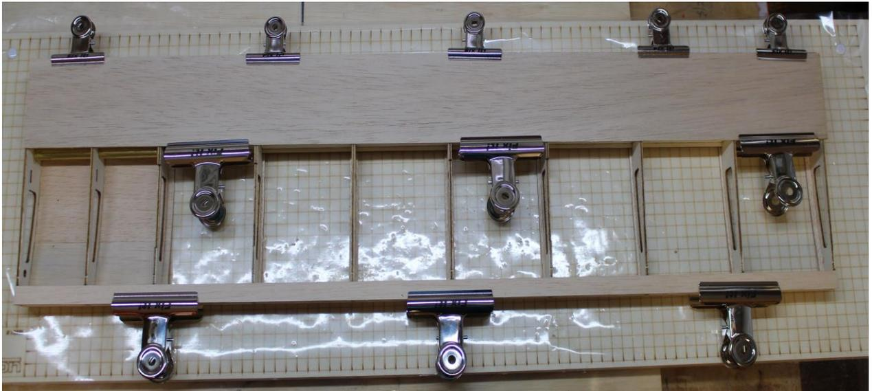
Tragfläche umdrehen, untere Nasenbeplankung 760×75 mm (1,5-mm-Balsa) zuschneiden und verleimen
