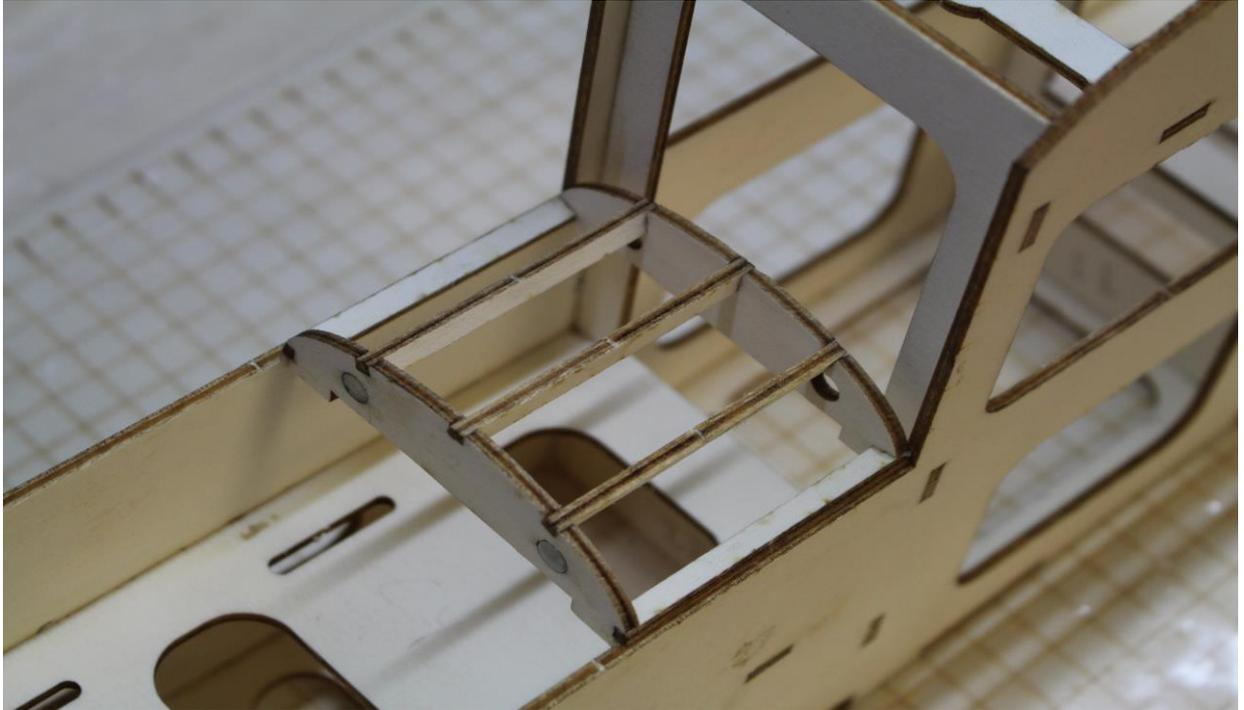
Einen Halbspann (E2 mit Magneten) und einen Halbspann (E2 ohne Magneten) zusammen mit den 5 Gurten (D3) auf dem Rumpf verleimen
