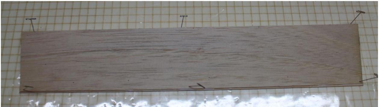
Beplankungsteile auf Querruder bzw. Landeklappe auflegen und ausrichten. Mit einigen Stecknadeln gegen Verrutschen sichern
