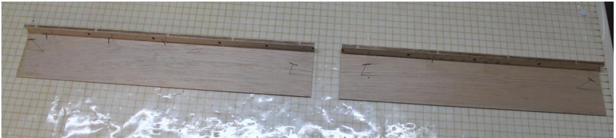
Untere Beplankungen für Querruder (357×70 mm) und Landeklappen (395×70 mm) zuschneiden
