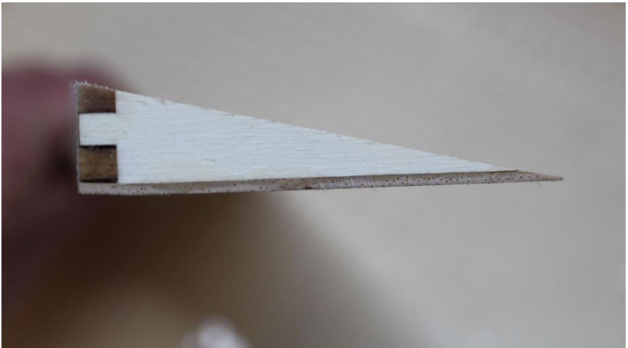
Frontleiste (L1) und die Hinterkante der unteren Beplankung schräg gemäß Profilverlauf schleifen
