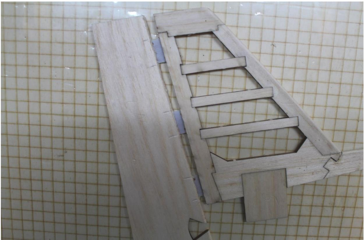
Schlitze für Fließscharniere anbringen, wir empfehlen hierzu das Scharnier Schlitz Set Best.Nr. C5829
