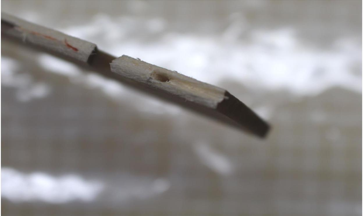
In das untere Ende des Seitenruders eine 2-mm-Bohrung (rechtwinklig) und eine 2 mm breite Nut anbringen.
