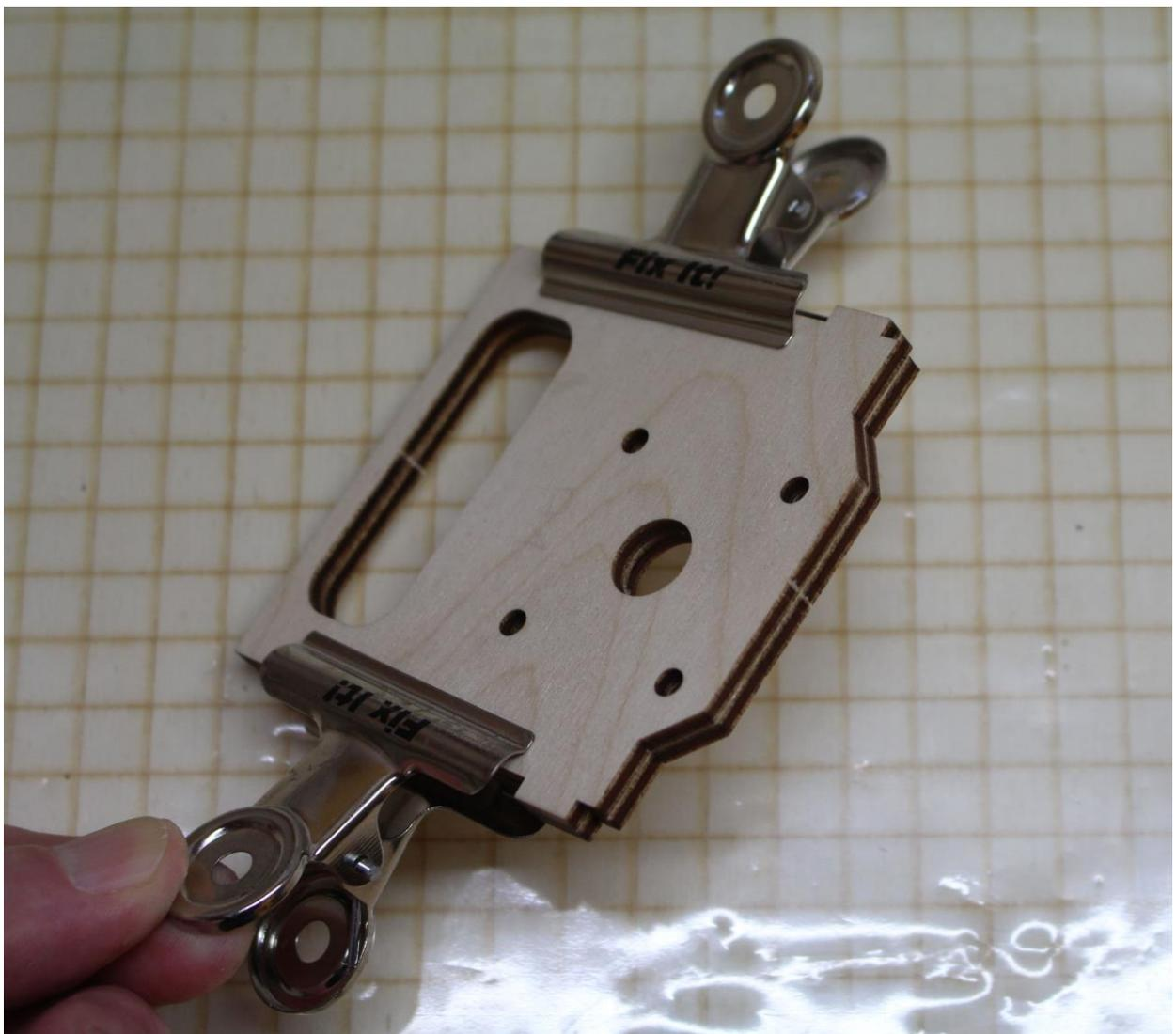
Motorspant aus 2x (A1) verleimen
