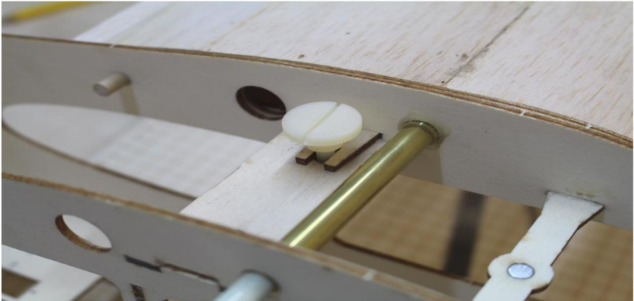
Zum Sichern der Tragfläche am Rumpf Rändelschraube (Kunststoff M5) eindrehen und handfest anziehen
