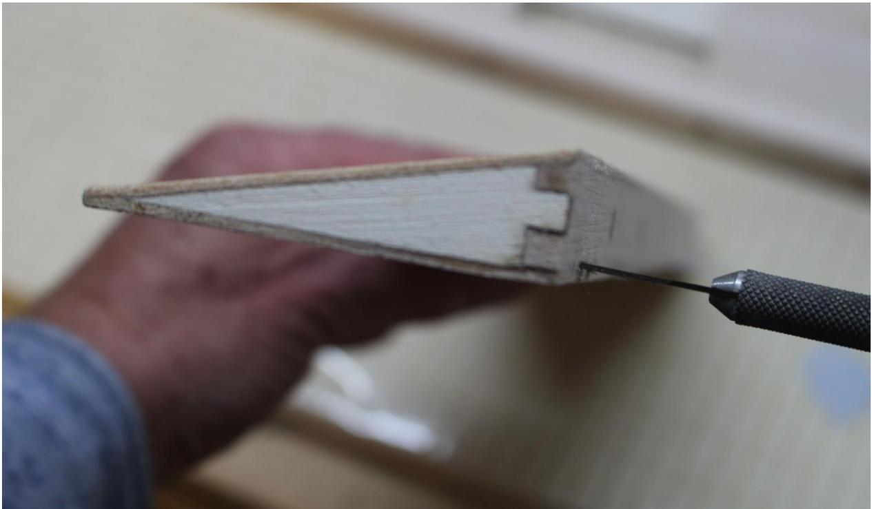
Scharnierschlitz in Querruder, Landeklappen und Tragfläche knapp unterhalb der Beplankung anbringen
