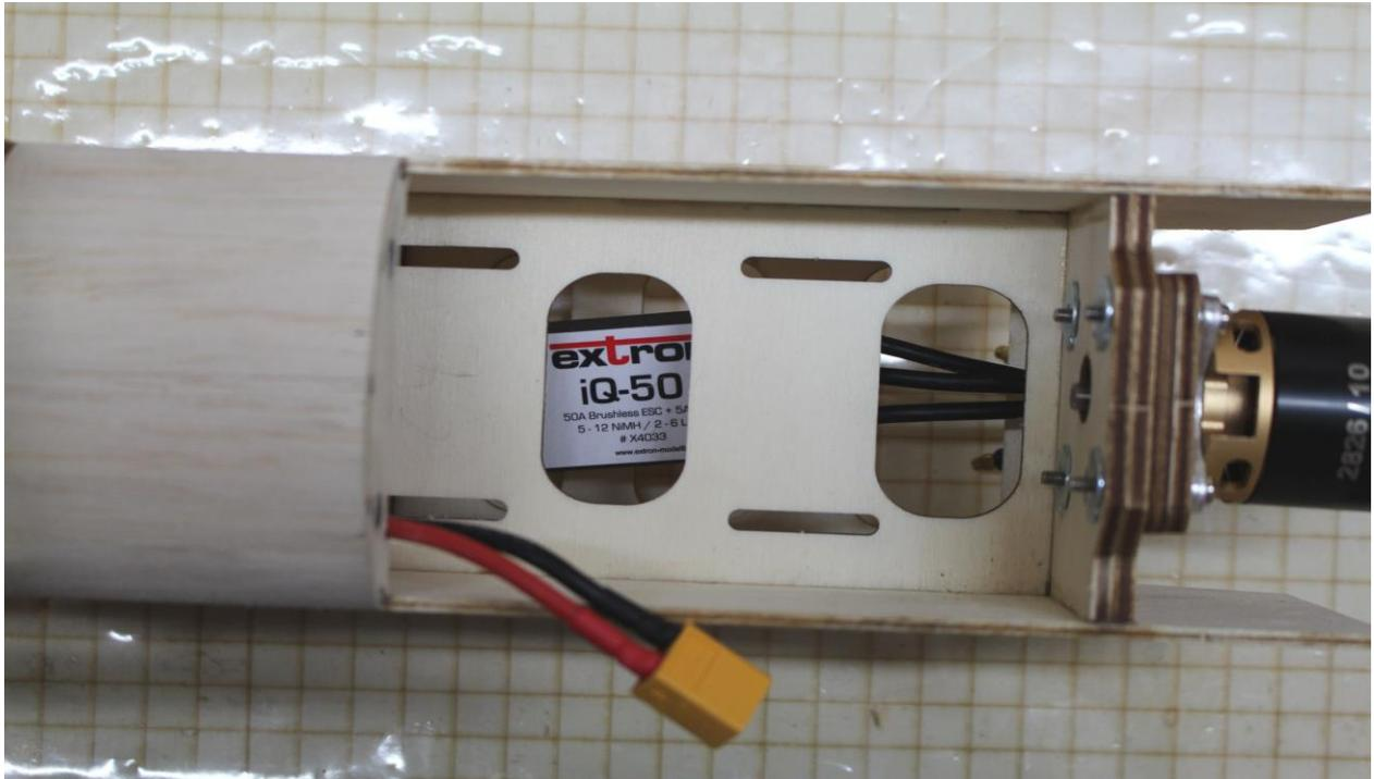
Den Regler von vorne durch die Lüftungsöffnung im Motorspant (A1) in den Rumpf einschieben und unter dem Akkubrett mit Klettband befestigen.
