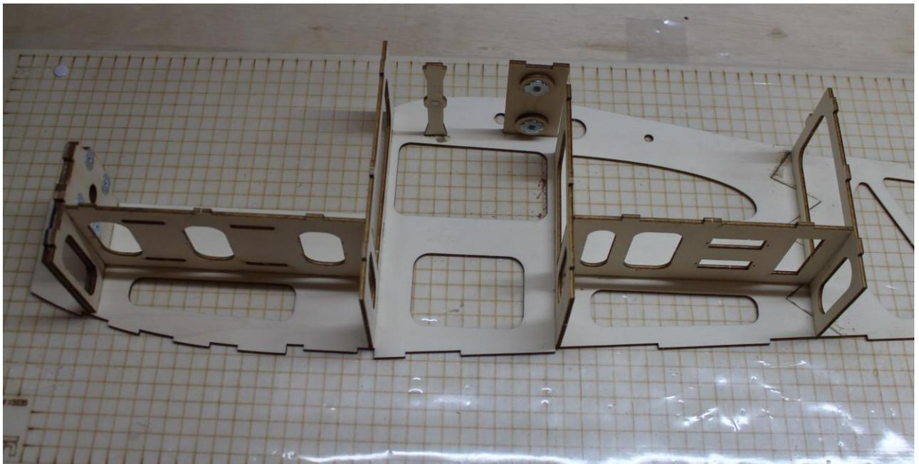
Akkuauflage (C4), Spant (B2), Quersteg (B7 längere Ausführung), Querträger (A3), Spant (B3), Servobrett (C5) und Spant (B4) mit Rumpfseitenteil verleimen
