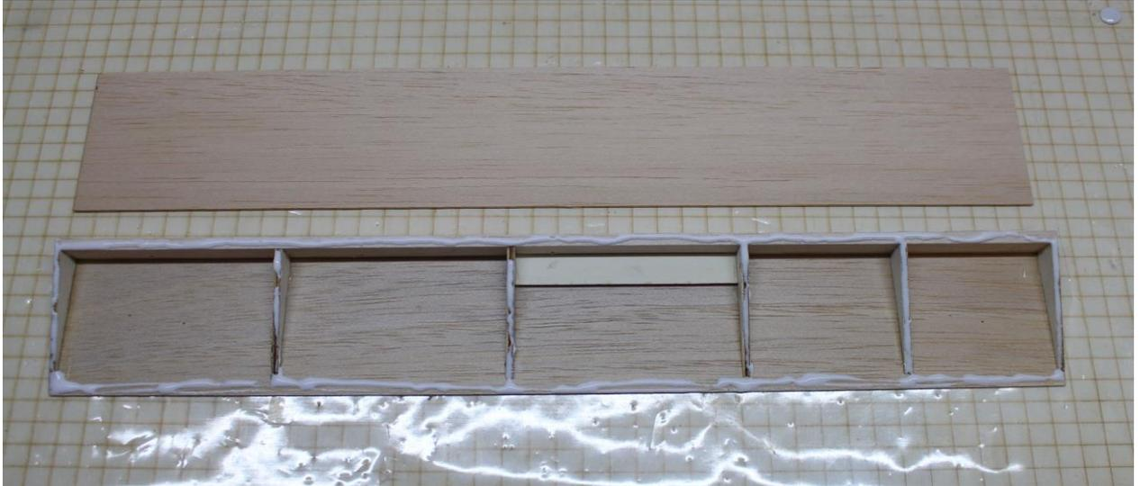
Obere Beplankungsteile (1,5-mm-Balsa) für Querruder (360×75 mm) und Landeklappen (400×75 mm) zuschneiden
