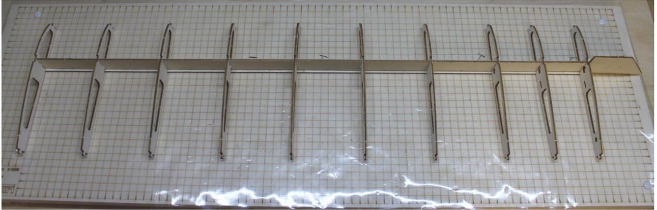
Rippen in Rippenkamm einstecken und verleimen in folgender Reihenfolge (J5, J4, J3, J2, J1, J2, J2, J1, J1, J1, von rechts nach links)
