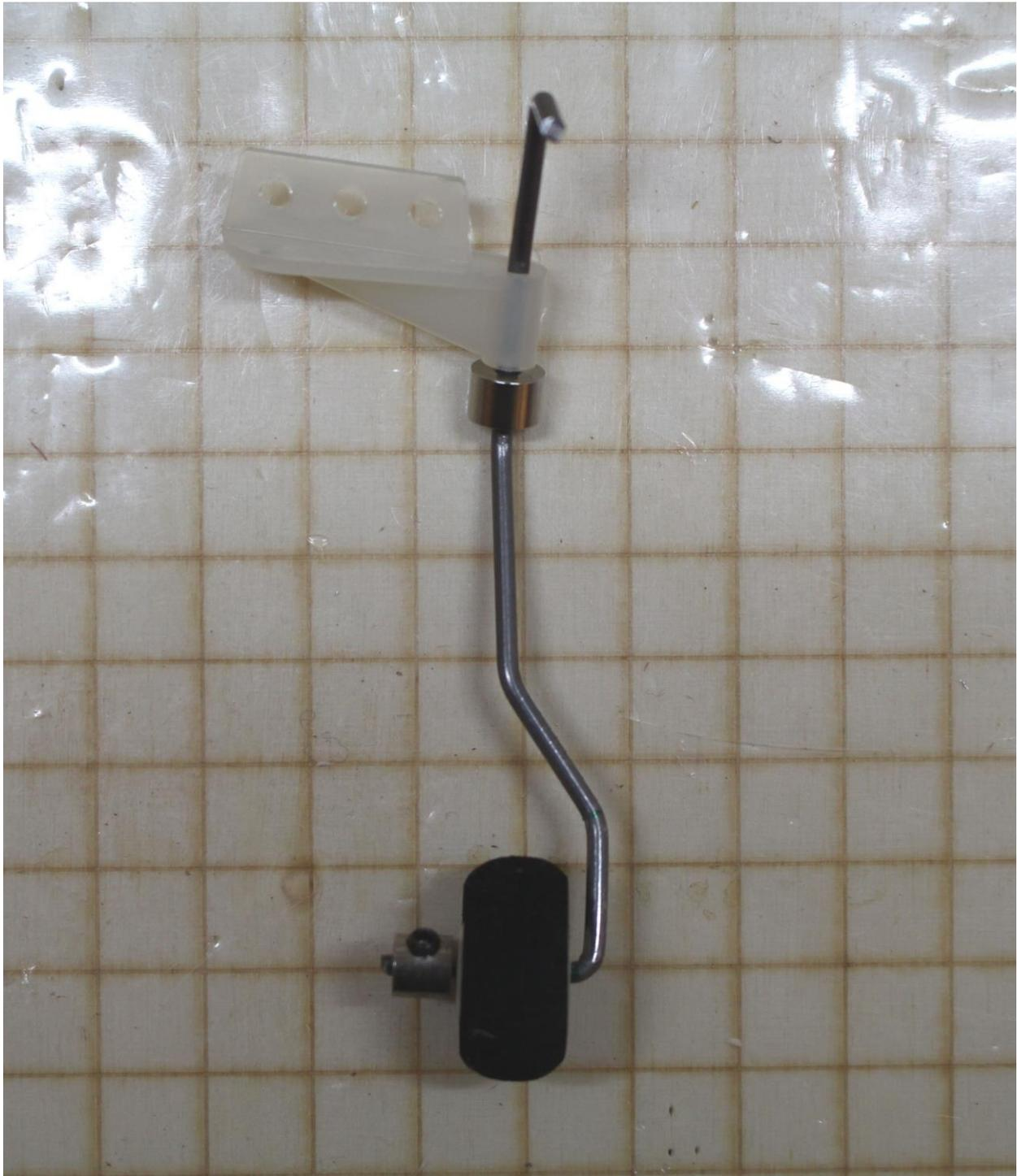
Draht für das Heckfahrwerk gem. den Abbildungen biegen. Zum Abnehmen der Maße können die Quadrate (10 mm Kantenlänge) der Bauunterlage verwendet werden.
