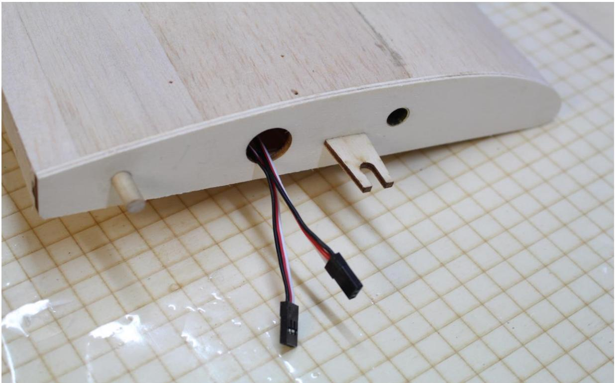
Beide Servokabel Richtung Wurzelrippe durch Öffnung ziehen
