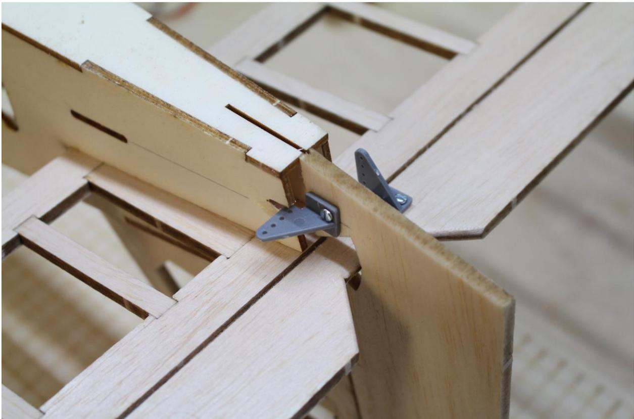
Ruderhörner auf Seiten- und Höhenruder mit Gegenplatte und 2× Blechschraube Ø2,2×12 mm verschrauben
