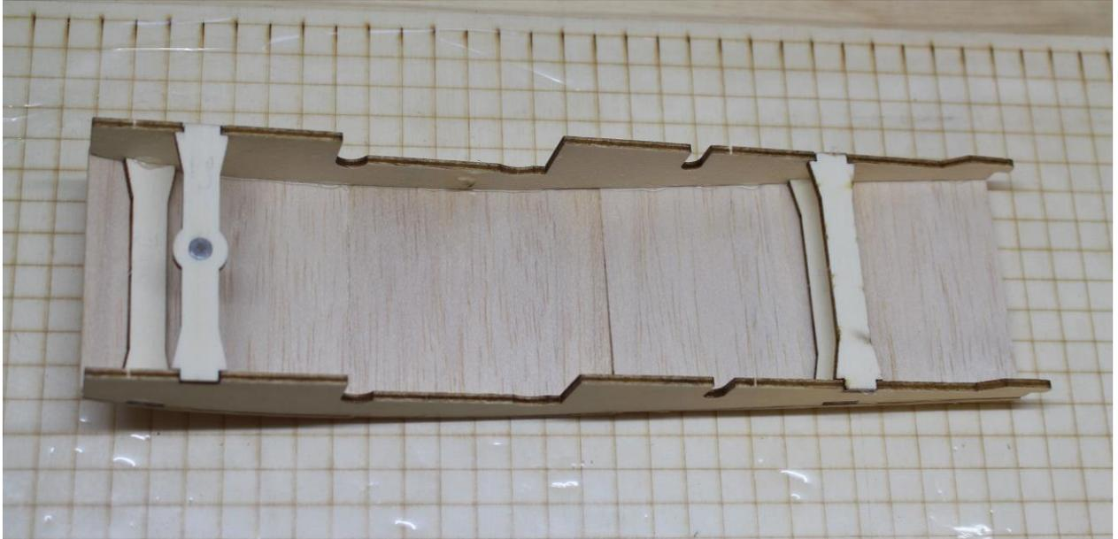
Quersteg mit Magnet (B7 kurze Ausführung), Querstege (B6, B7) mit Deckelseitenteilen verleimen
