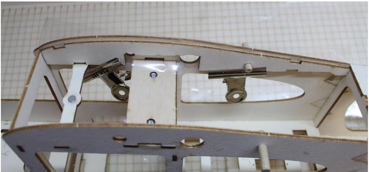
Deckelseitenteile (B5) in Rumpf einstecken und ausrichten – **nicht mit Rumpf verleimen**
