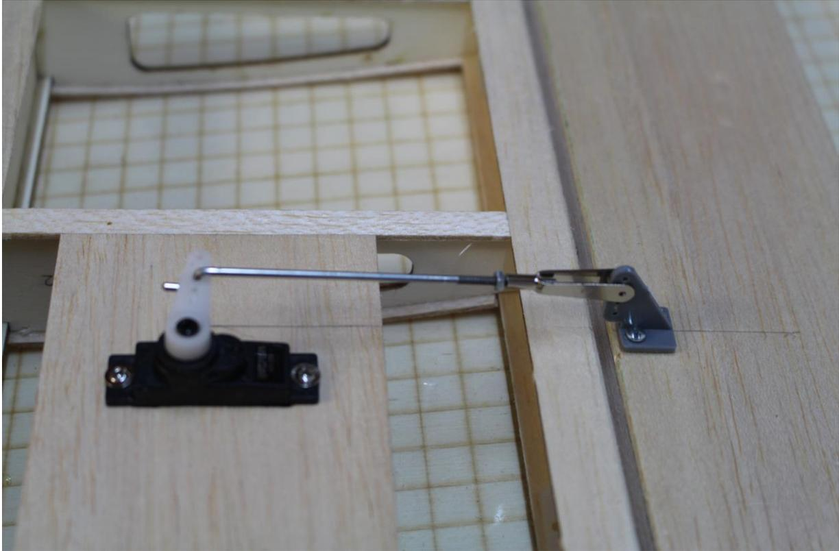
Anlenkdraht an Servohebel und Ruderhorn einhängen. Neutralstellung durch Verdrehen des Gabelkopfes einstellen.
