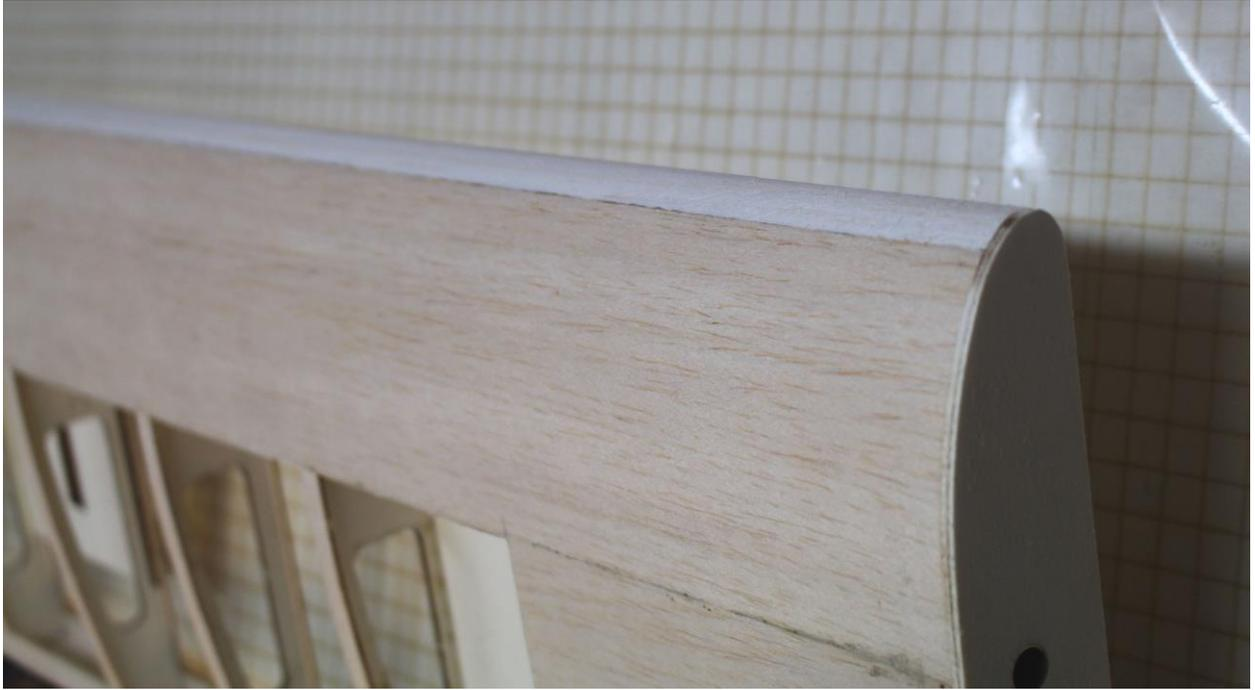
Nach dem Trocknen die Nasenleiste (K2) entsprechend dem Profil der Deck- und Abschlussrippe hobeln und verschleifen
