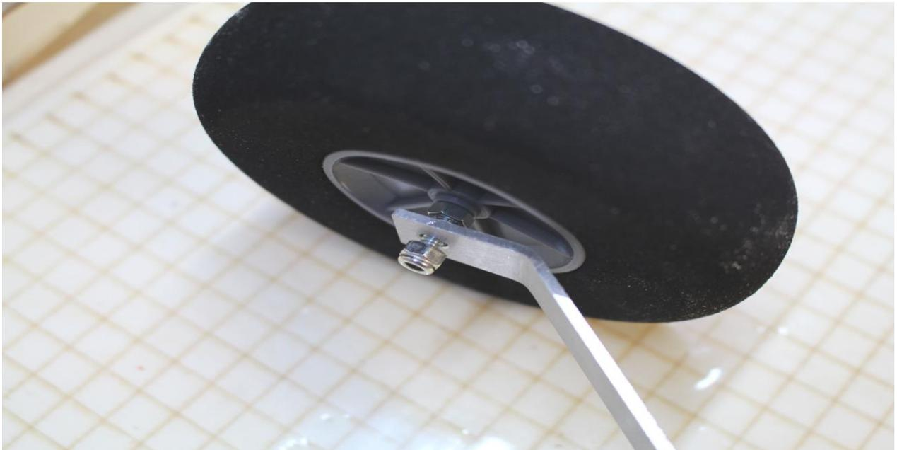
Radachse (Schraube M5×40 mm) in Radnabe stecken (ggf. Nabe auf Ø5 mm aufbohren)
