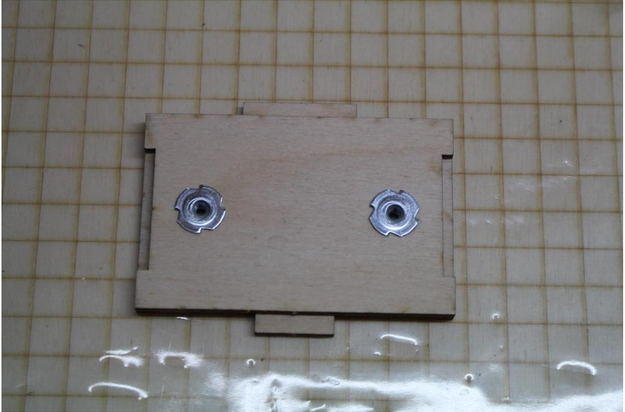
2× Einschlagmuttern M3 für Fahrwerksverschraubung einziehen
