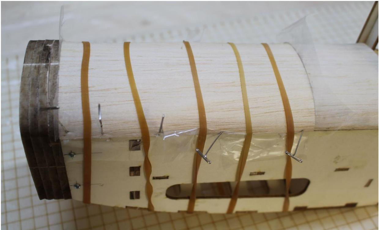
Beplankungsteile aus 1,5-mm-Balsa zuschneiden, bündig einpassen und aufleimen
