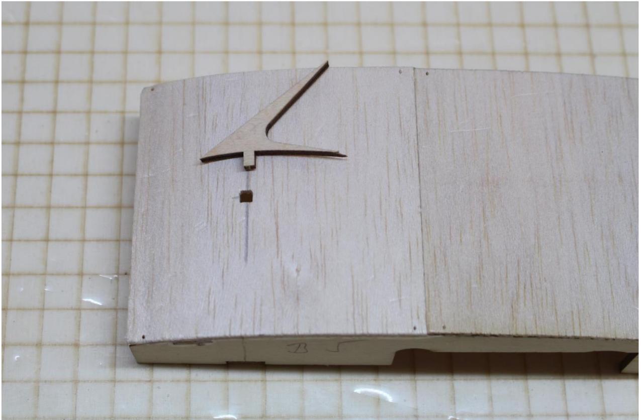
Auf Höhe des Querstegs mit Magneten einen Durchbruch 3×3 mm mittig in der Beplankung anbringen
