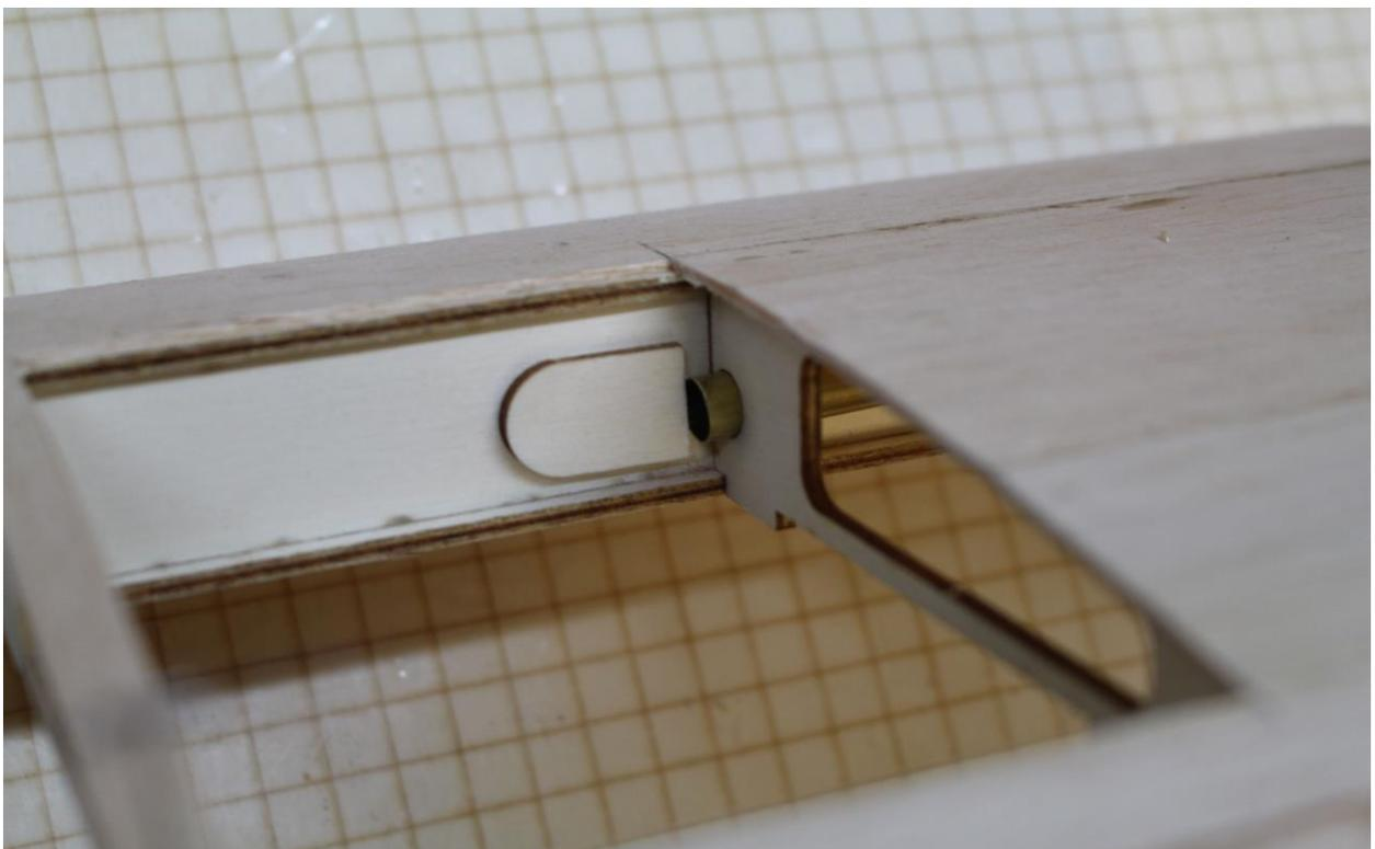
Aus einem Stück Restholz Anschlag zuschneiden und verleimen.
