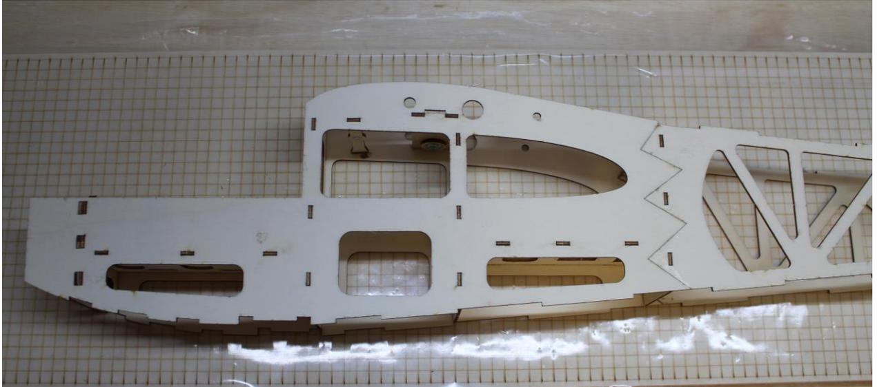
Zweites Rumpfseitenteil auf Spantengerüst auflegen und verleimen
