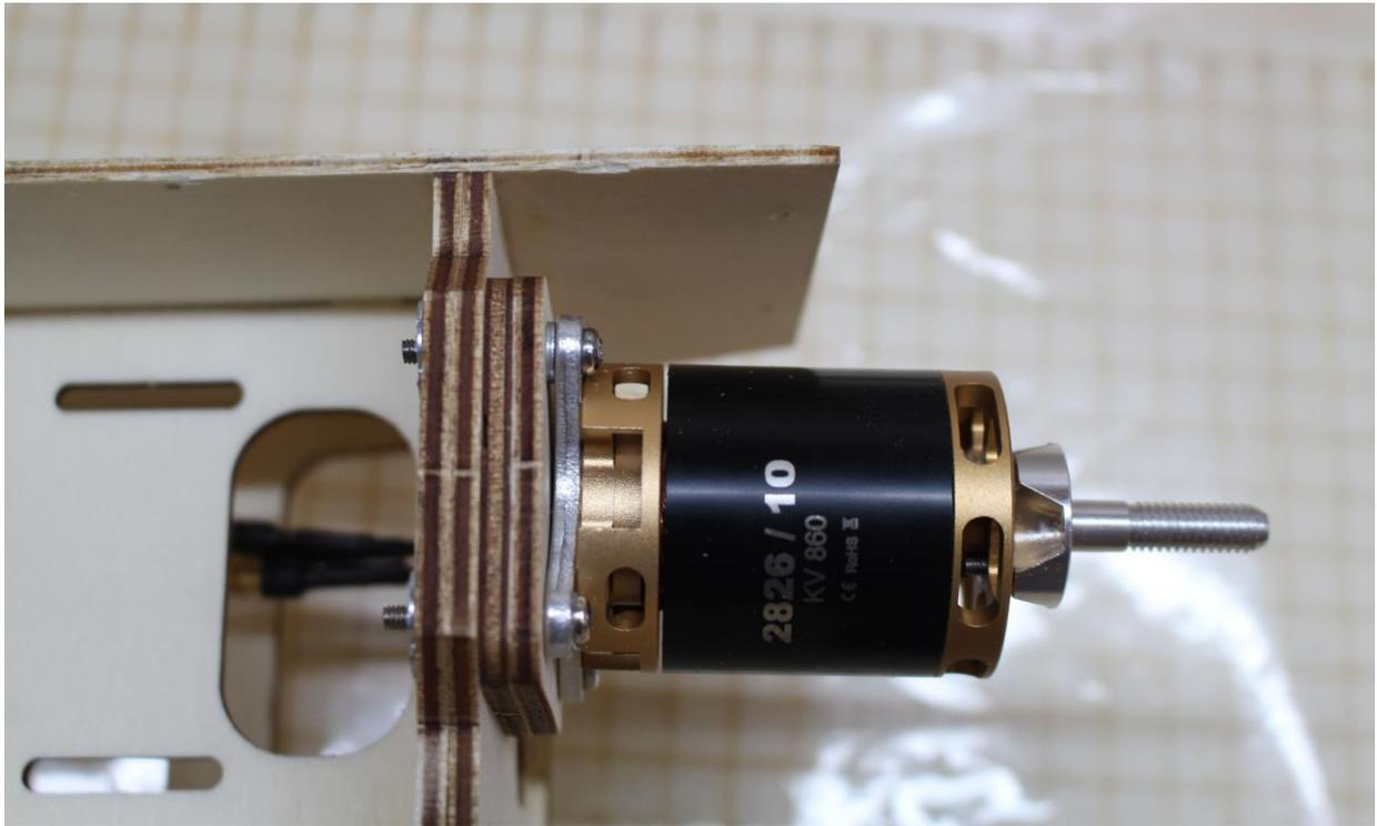
Motor mit 4× Schraube M3×20 an den Distanzscheiben verschrauben. Die Motoranschlusskabel zeigen dabei nach unten. Zum Einstellen des Seitenzuges unter die beiden rechten Schrauben (von vorne gesehen) je 2× Unterlegscheibe zwischen Montagestern und Distanzscheiben (A8) legen. Die Motorwelle muss genau mittig in der Frontverkleidung zu liegen kommen.
