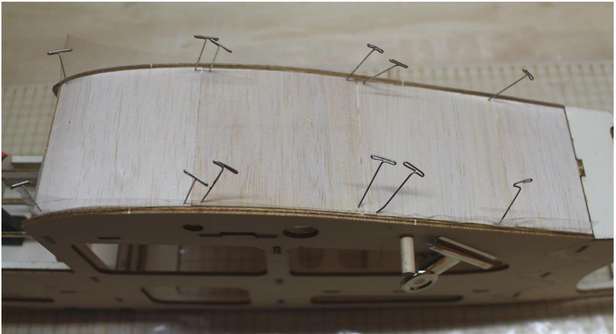
Bepankungsteile aus 1,5-mm-Balsa zuschneiden und auf Deckelseitenteile (B5) verleimen
