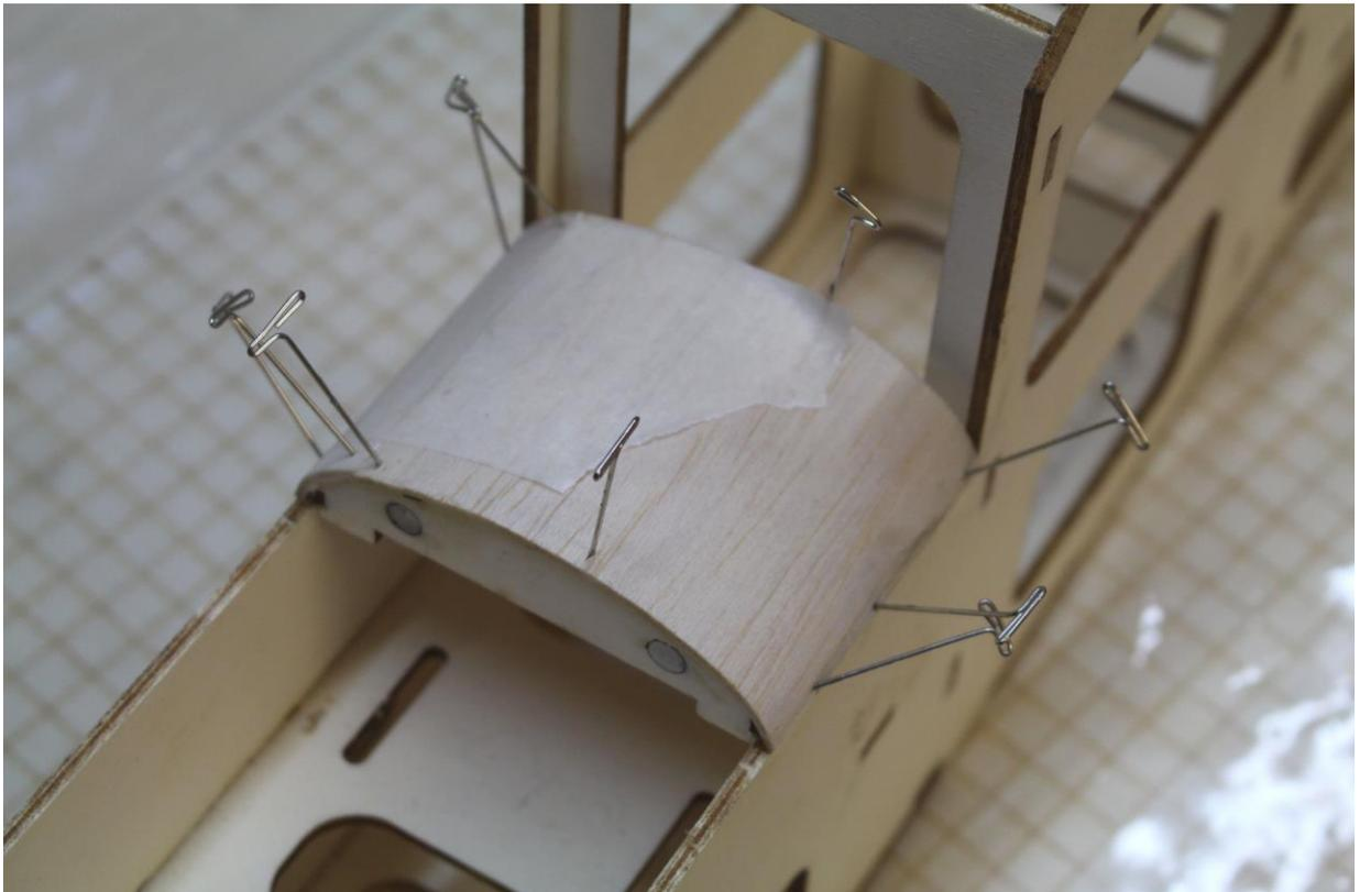
Beplankungsteile aus 1,5-mm-Balsa zuschneiden und aufleimen.
