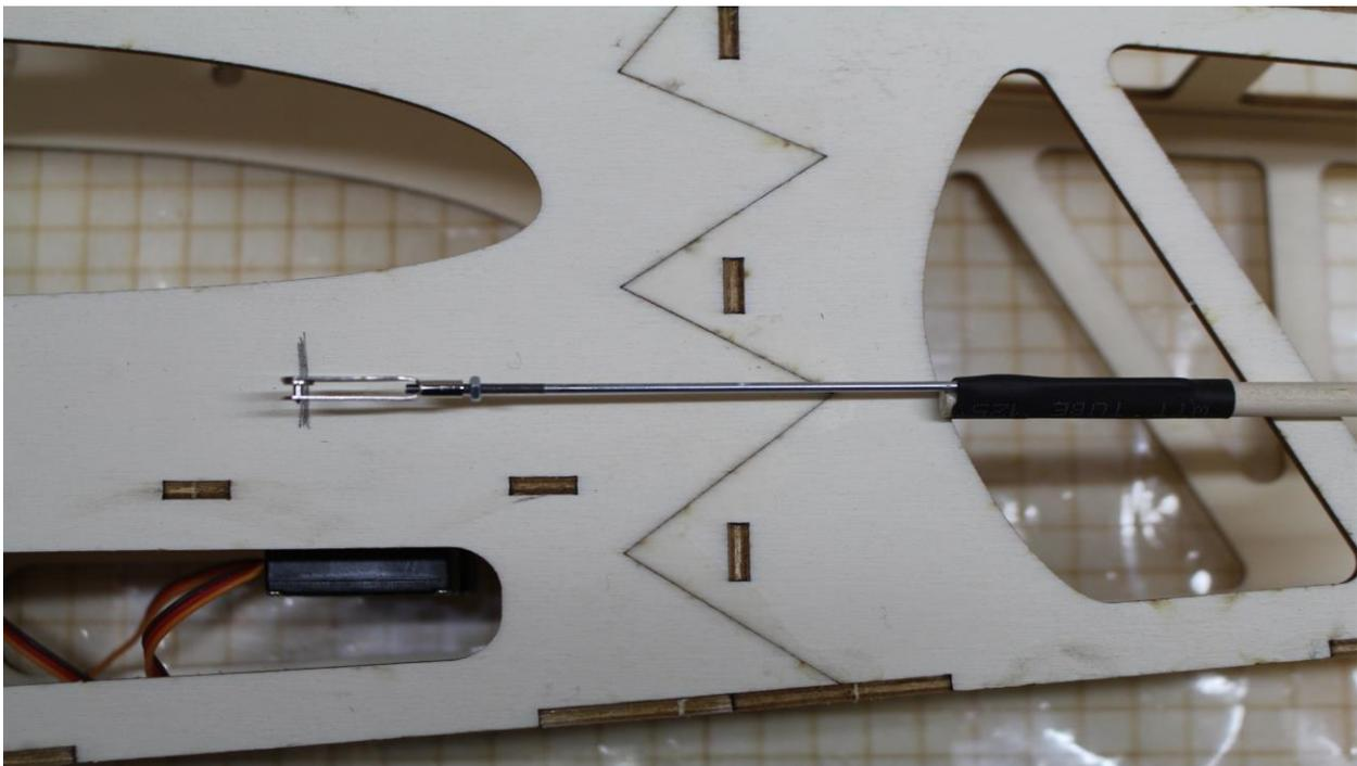
Lage des Servohebels an der Rumpfseitenwand anzeichnen
