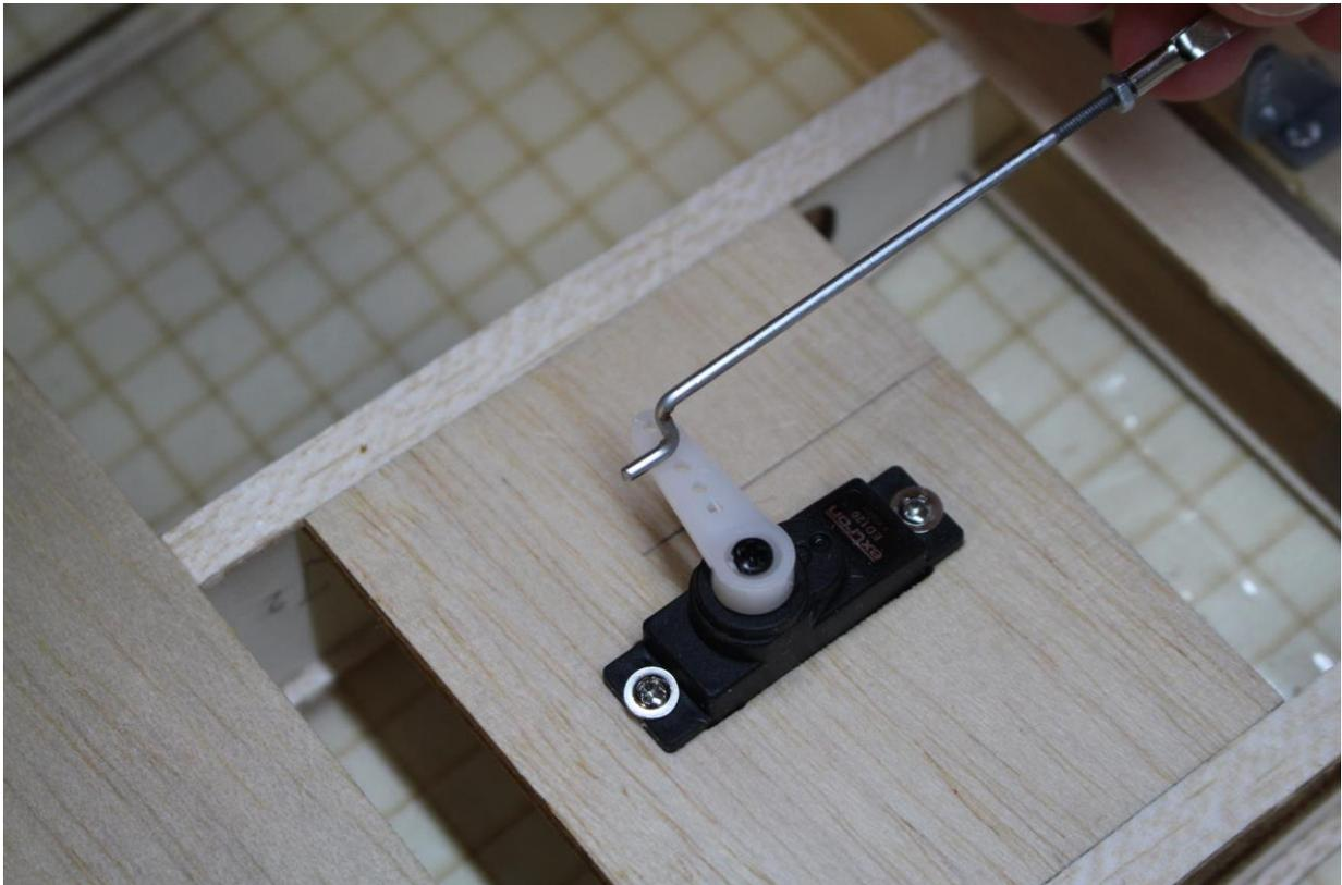
An Markierung Anlenkdraht 2× um 90° biegen (Z-Anschluss)
