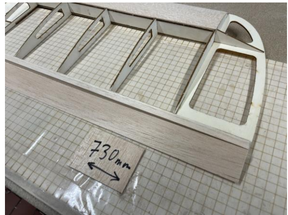
Untere Kante ca. 30 Grad anschleifen
