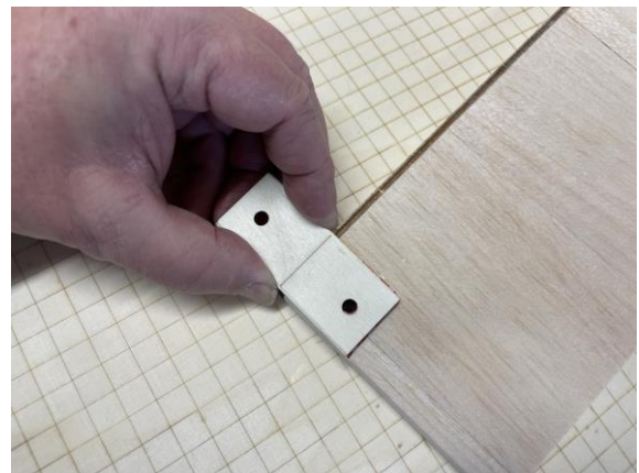
Am Sperrholzteil B10 einen Mittelstrich markieren und als Bohrhilfe für die Tragflächenschrauben verwenden.
