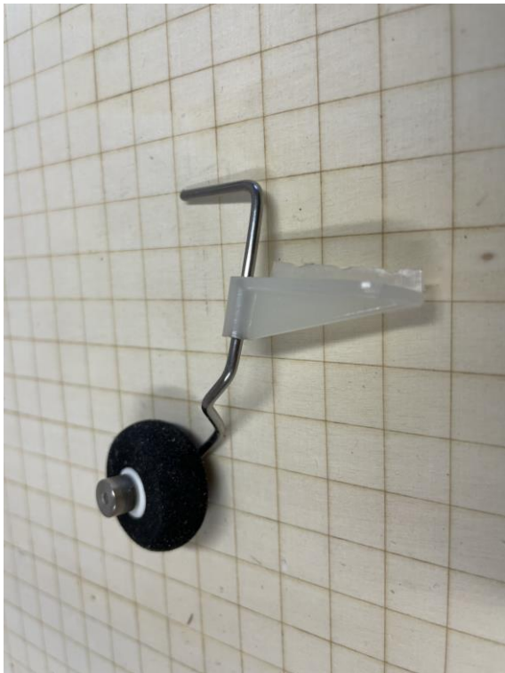
Spornrad mit Stelling montieren.
