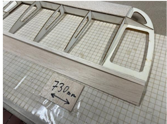
Untere Kante ca. 30 Grad anschleifen
