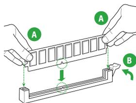
So entfernen Sie ein DIMM
