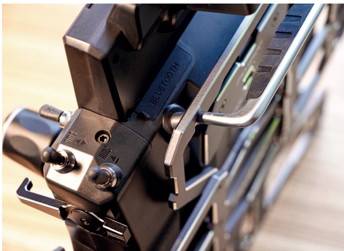
Um Kratzer zu vermeiden wird das Pult am Haltegriff der Anlage fixiert. Das Gegenlager bildet eine Klemmvorrichtung welche gegen den Kunststofffuß drückt
