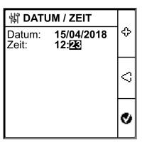
3. Stellen Sie das Datum und die Uhrzeit mit Hilfe der Kontextmenü-Tasten und die Uhrzeit mit Hilfe der Kontextmenü-Tasten
