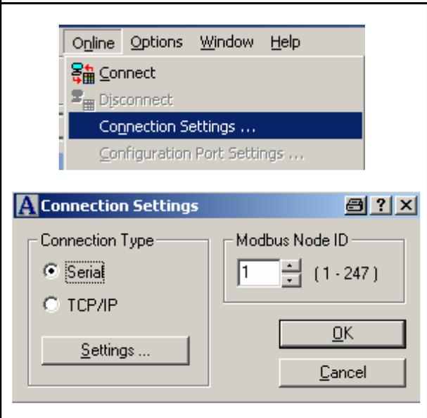
8 Über **Online -> Connect** eine Verbindung herstellen. Dabei wird die Version der Konfiguration im NIM und PC verglichen. Stimmt diese nicht überein wird nebenstehendes Fenster angezeigt.
