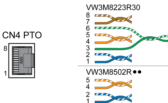
连续脉冲输出 (PTO) 接线图
