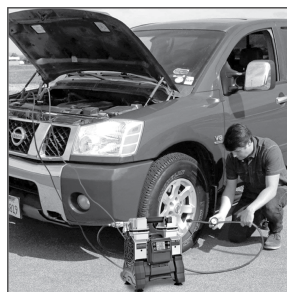
Accu via kabels (DC)
