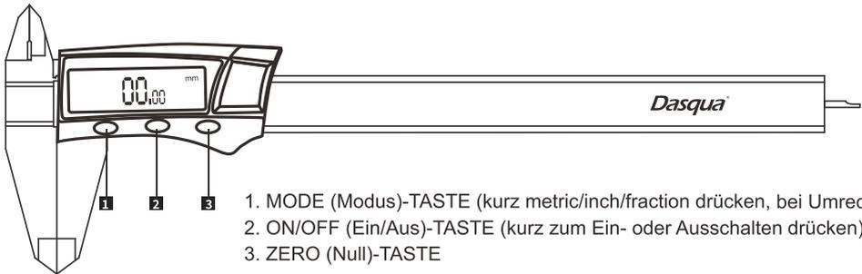
1. MODE (Modus)-TASTE (kurz metric/inch/fraction drücken, bei Umrechnung)
