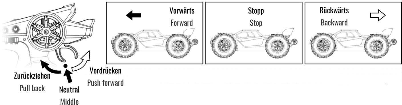
**Bremse:** wenn das Fahrzeug vorwärtsfährt, drücken Sie den Gashebel nach vorne, das Fahrzeug bremst ab. Um Rückwärtszufahren, lassen Sie den Gashebel in die Neutralstellung und drücken Sie ihn erneut nach vorne.
