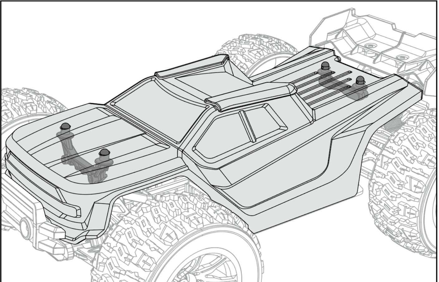
2. Stecken Sie die vier Klammern in die Löcher der Karosseriehalter, um die Karosserie zu verriegeln.
