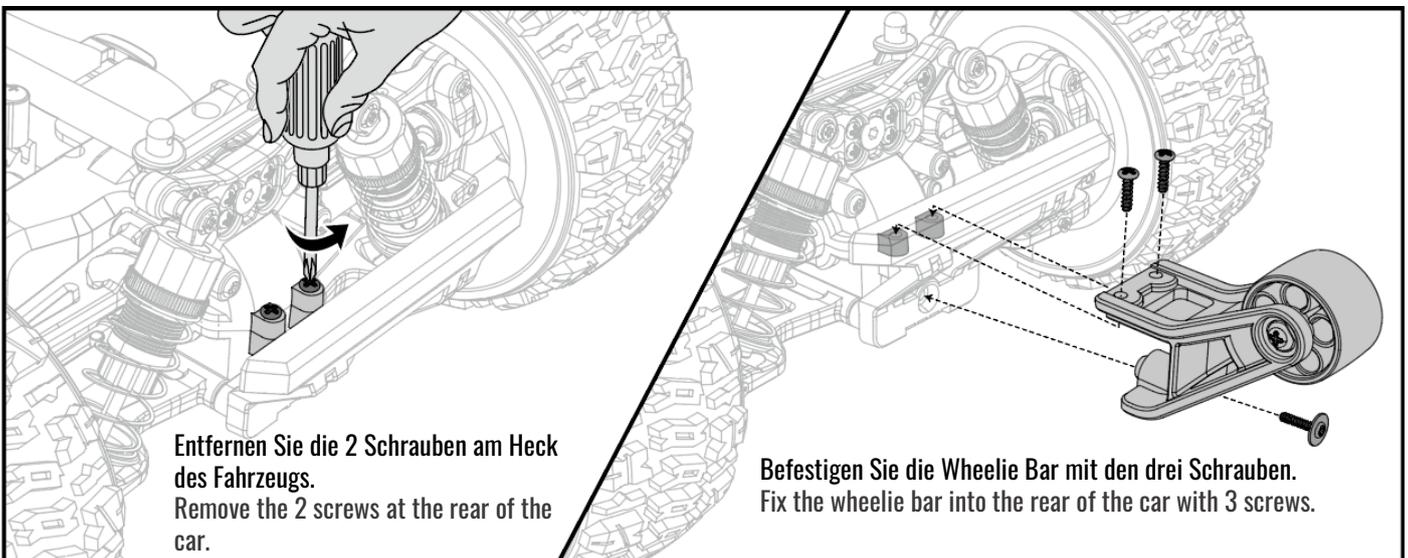
Entfernen Sie die 2 Schrauben am Heck des Fahrzeugs.
