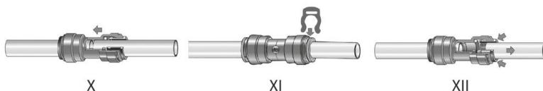
Uistite sa, že je hadica dostatočne dlhá, aby ste zabránili napnutiam na jednotlivých komponentoch alebo spojoch. Uistite sa, že hadica nie je zalomená, aby ste zaistili rovnometrny vtok vody. Hadica nesmie prísť do kontaktu s ostrými hranami alebo horúcimi prístrojmi (napr. potrubia horúcej vody). Vhodné pre rozsah teploty +1°C – +20 °C, max. prevádzkový tlak 10 barov, max. pretlak 30 barov. Odporučame hadicu upevniť vhodnými svorkami na kuchynský stenu.
