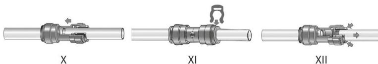
Zorg ervoor dat de slang lang genoeg is om spanning op de afzonderlijke onderdelen of aansluitingen te voorkomen. Zorg ervoor dat de slang niet geknikt is om een gelijkmatige watertoever te garanderen. De slang mag niet in contact komen met scherpe randen of hete apparaten (bijv. warmwaterleidingen). Geschikt voor een temperatuurbereik van +1°C - +20°C, max. werkdruk 10 bar, max. barstdruk 30 bar. Wij raden u aan de slang met geschikte klemmen aan uw keukenmuur te bevestigen.
