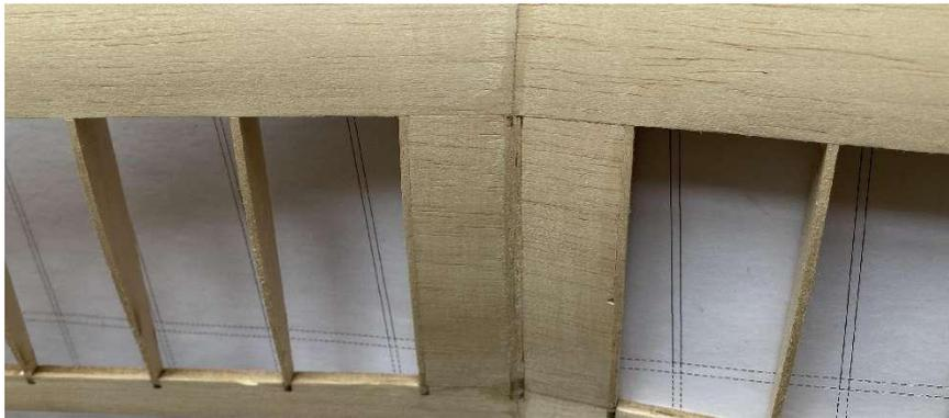
**24. Zusammenbau und verkleben des Leitwerks. ACHTUNG: Das Leitwerk muss bereits vor der Montage bespannt werden.**
