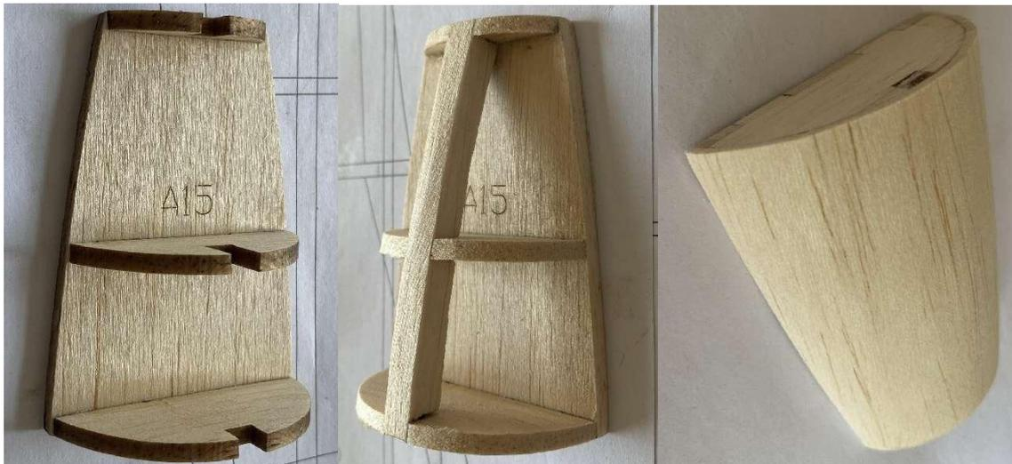
**8. Vorderteil der Flächenaufnahme aus 2 Stück 5 mm Balsa anfertigen und in Form schleifen.**
