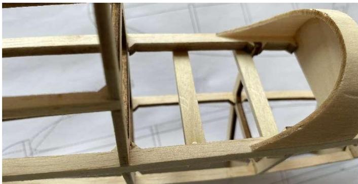
11. Rumpfnase Stück für Stück verkleben und in Form schleifen. ACHTUNG: Motor muss bereits vor dem Anbringen der Rumpfnase installiert werden.
