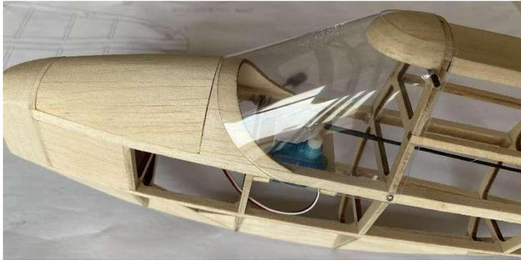
**28. Der Rohbau ist nun fertiggestellt. Nachdem alle Bauteile sorgfältig verschliffen wurden, kann das Modell bespannt werden. Dazu empfehlen wir uneingeschränkt unser Japan Air Bespannpapier. Die komplette Farbauswahl finden Sie unter [www.pichler.de](http://www.pichler.de).**
