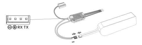
3.2 Wenn der ESC nicht über eine individuelle Programmierschnittstelle verfügt, dann wird der Pin benötigt. Verbinden Sie das ESC-Signalkabel mit dem Bluetooth-Modulkabel gemäß dem unten gezeigten Anschlussplan. Ein spezieller Stift sollte benötigt werden, wenn Sie beide verbinden, achten Sie darauf, die gleiche Farbe Kabel sollte entsprechend angeschlossen werden, und schließen Sie dann den ESC an die Batterie.
