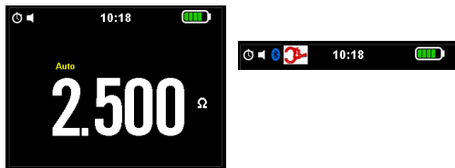
Fig. 3: Mesure de la résistance de terre
