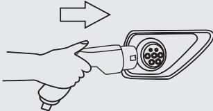
Una volta convalidata la scelta del calibro di carica, collegare il prodotto al veicolo. Il cavo di ricarica viene visualizzato **Chg** sul display (collegato).
