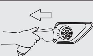
Quando il veicolo è completamente carico, il cavo di ricarica viene visualizzato **End** sul display.
