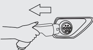
Когда автомобиль полностью заряжен, на дисплее отображается **End**. В случае если автомобиль решит возобновить зарядку, зарядный кабель перезапустится автоматически. Отсоедините зарядный кабель от автомобиля.
