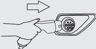
Una vez validada la elección del tamaño de carga, conecte el producto al vehículo. El cable de carga aparece en la pantalla **Conn** (conectado).
