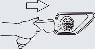
Une fois le choix du calibre de charge validé, connecter le produit au véhicule. Le câble de charge indique **Link** à l'écran (connecté).
