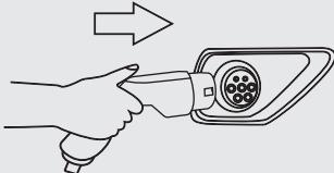
Wanneer u de keuze betreffende het laad-kaliber heeft bevestigd, kunt u het apparaat aankoppelen aan het voertuig. De laadkabel geeft **End** aan op het scherm (aangesloten).
