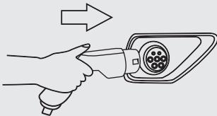
Nachdem Sie die Wahl der Ladeleistung bestätigt haben, schließen Sie das Produkt an das Fahrzeug an. Das Ladekabel zeigt **[End]** auf dem Bildschirm an (verbunden).
