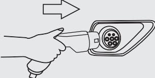
После подтверждения выбора размера заряда подключите устройство к автомобилю. На дисплее отображается кабель для зарядки **End** (подключен).
