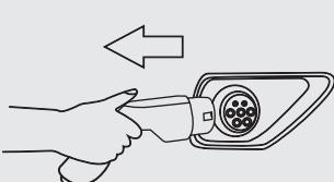
Lorsque la charge du véhicule est complète, le câble de charge indique **End** à l'écran.
