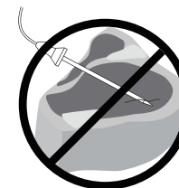
(Imagem C) Colocação incorreta da sonda
