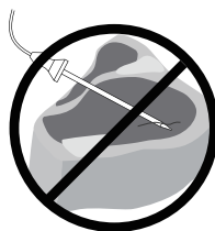
(Figura C) Colocación incorrecta de la sonda
