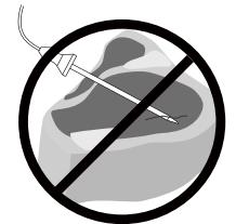
(Abbildung C) Fehlerhaft angebrachter Sensor
