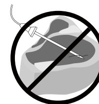
(Imagem C) Colocação incorreta da sonda
