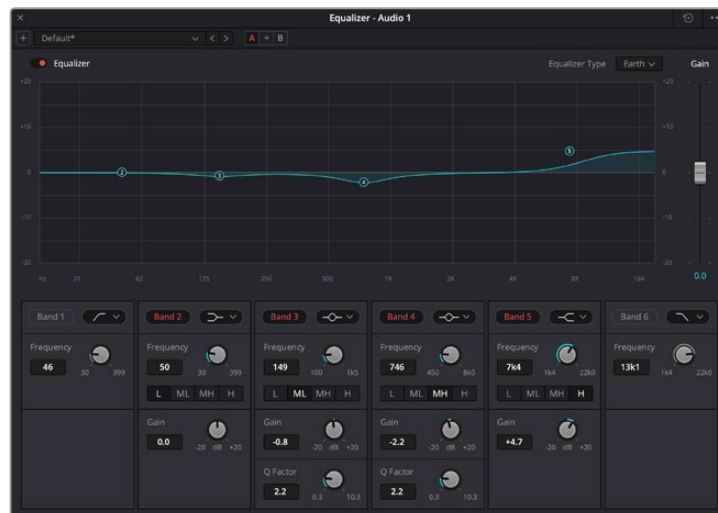
Ecualizador paramétrico de 6 bandas que puede aplicarse a cada pista
