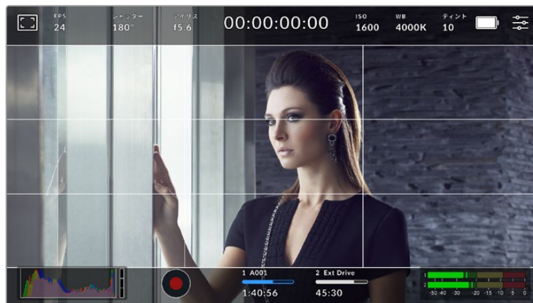
3x3グリッドのグリッドはスクリーンのフレームガイドに合わせて自動的に調整されます。
