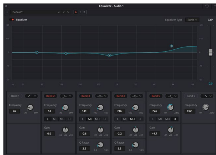
O equalizador paramétrico de 6 bandas que pode ser aplicado a todas as trilhas.
