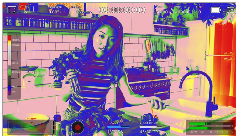
In einem ausgewogen belichteten Bild werden Hauttöne als grüne und rosa Falschfarben dargestellt
