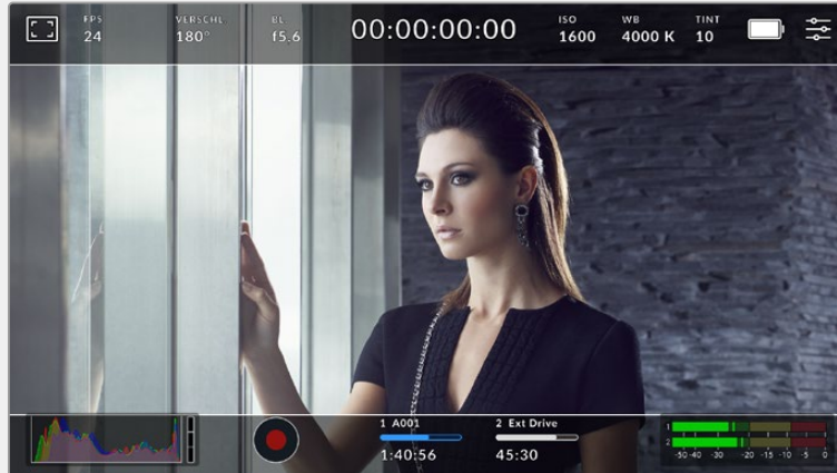
LCD-Touchscreen mit aktivierten 2,40:1-Bildrandmarkierungen
