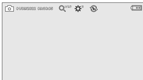
Juster in kamerahuvudet på flexslangen och placera det i den önskade positionen. Slå på lysdiodsbelysningen, om ljusförhållandena är dåliga. Zooma in avlägsna eller små objekt. Genom den manuella bildrotationen kan bilden på monitorn vridas 180°. Tryck kort på OK-knappen för att ta bilden eller spela in videon och spara den på SD-kortet. Ett tryck till avslutar inspelningen.
