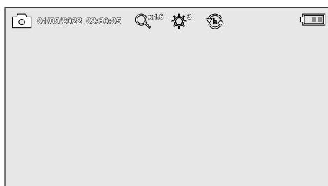
Oriente a cabeça da câmara no tubo flexível e coloque-a na posição pretendida. Com condições de luminosidade insuficientes, ligue a iluminação LED. Aproxime objetos afastados ou pequenos com o zoom. Com a rotação manual da imagem é possível rodar a imagem 180° no monitor. Premindo brevemente a tecla OK, a imagem ou o vídeo é captada/o e gravada/o no cartão SD. Ao voltar a premir é terminada a gravação.
