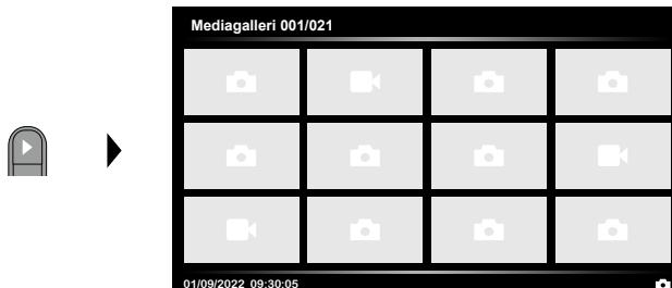
Tryck på knappen "d" för att hämta mediagalleriet. Bekräfta med "OK" så visas vald bild eller video i helbildsläge. Med pilknapparna kan du navigera i mediagalleriet och i helbildsläge. Genom att trycka på knappen "a" stängs återgivningsläget.
