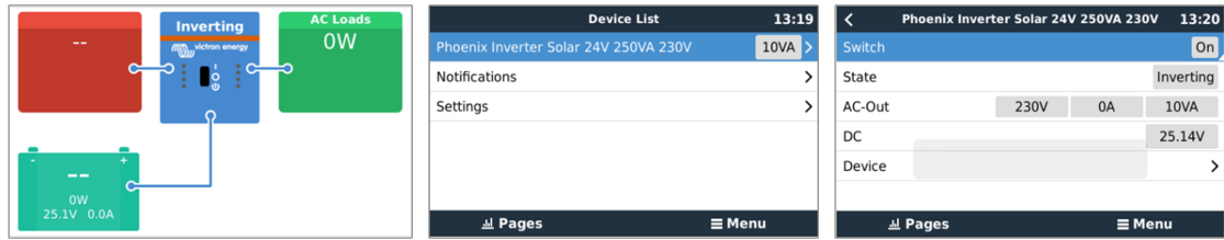
Beispiel für die Anzeigen des GX von links nach rechts: Systemanzeige, Geräteliste und Anzeige des Wechselrichters.
