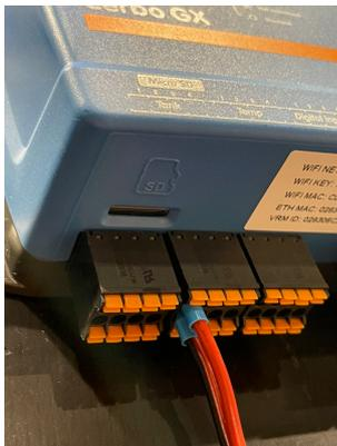
Sensoren werden über Einstellungen -> E/A -> Analoge Eingänge der GX-Geräteeinstellungen aktiviert (und deaktiviert).
