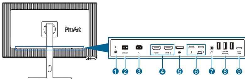
1. **Kensington-Schloss:** Dieser Anschluss nimmt zu Sicherheitszwecken eine Schloss- und Kabel-Vorrichtung auf.
