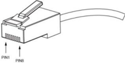
Questo cavo viene utilizzato per collegare la porta console dello switch al terminale di monitoraggio esterno. Un'estremità della spina RJ45 a otto pin, l'altra estremità è una spina a 25 fori (DB25) e una spina a 9 fori (DB9), RJ45 è inserita nella presa della porta console dello switch, DB25 e DB9 possono essere utilizzate in base ai requisiti della porta seriale del terminale, lo schema di collegamento interno del cavo è il seguente:
