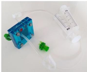
Bringen Sie eine Spritze an die obere Düse auf jeder Seite der Brennstoffzelle an (diese für die Gasspeicherung).
