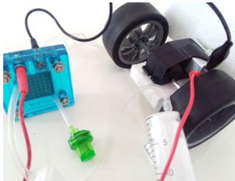
Eine Brennstoffzelle weist eine negative (Wasserstoff) und eine positive (Sauerstoff) Seite auf. Wenn die Brennstoffzelle benutzt wird, ist es wichtig, die richtigen Polaritäten (rot zu rot und schwarz zu schwarz) sicherzustellen, da sie die Richtung des Motors beeinflussen. Das bedeutet, dass das Auto rückwärtsfährt, wenn Sie die Polarität wechseln.
