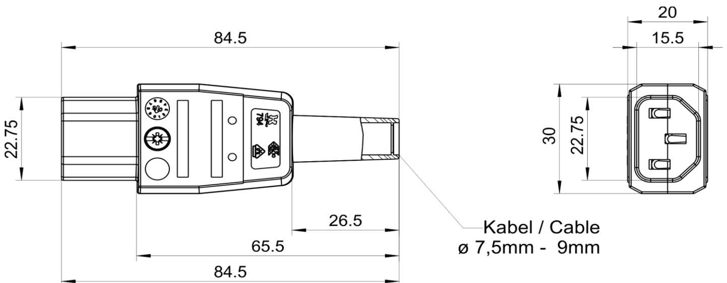
Abisolierung / Wire stripping: N 20 mm L 20 mm PE 20 mm
