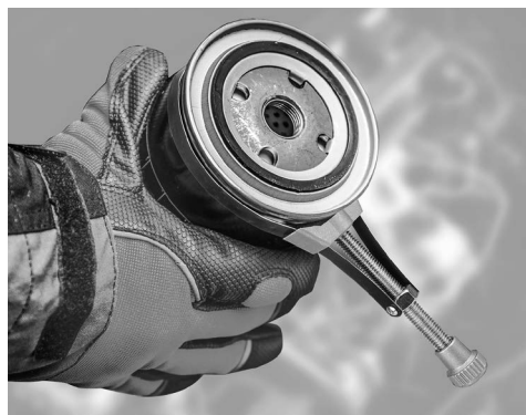
Figura 4: Svitare il filtro dell'olio
