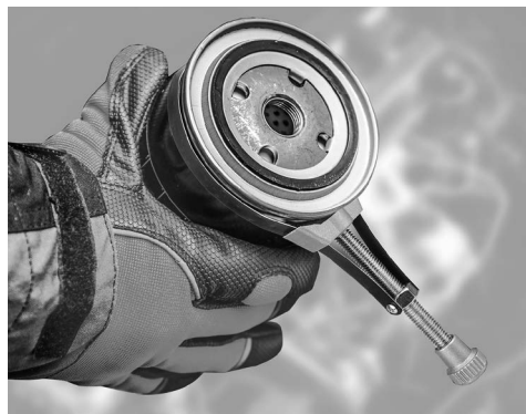
Afb. 4: Het oliefilter losschroeven
