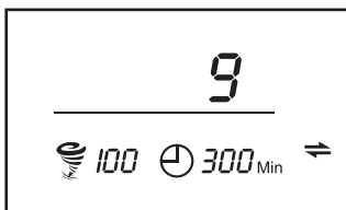
Adresscode für Kommunikationsanschluss einstellen
