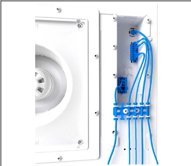
Abb. 20: Herstellen der Zugentlastung mit Kabelbindern (beispielhafte Darstellung)
