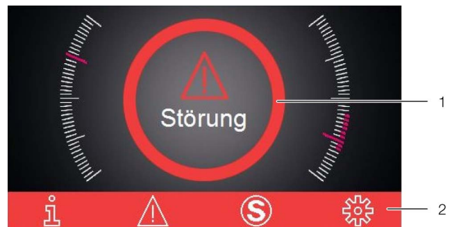
Abb. 26: Bildschirm bei Auftreten einer Störung
