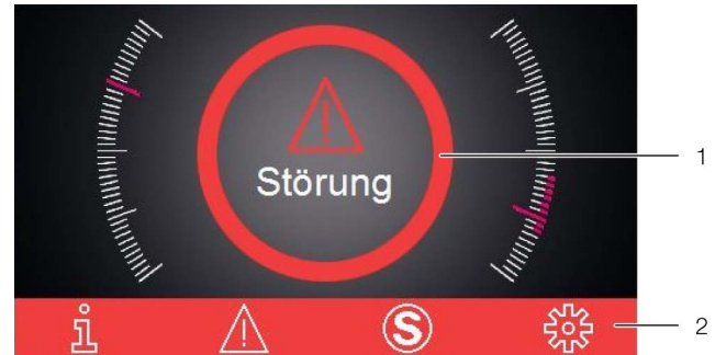
Abb. 47: Bildschirm bei Auftreten einer Störung
