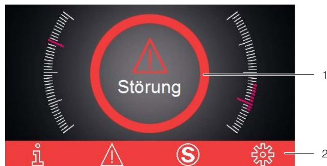
Abb. 44: Bildschirm bei Auftreten einer Störung
